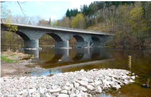
Abbildung 53 zeigt den neu errichteten Pegel bei Ziegenrück an der *Saale*. Die von einem Einperlsensor erfassten Wasserstandsdaten werden an das TLUBN fernübertragen. Gleichzeitig erfolgt eine Anzeige der Wasserstände auf einer Anzeigetafel im Wasserkraftmuseum Ziegenrück. Diese besondere Art der Wasserstandsveröffentlichung kann der Informations- und Verhaltensvorsorge vor Hochwasser dienen (Kapitel 3.6).
