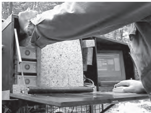
Slika 1: Merilni inštrumenti na kabini traktorja
