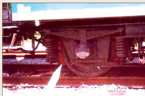
Slika 12: Zavorne obloge kot povzročitelj gozdnih požarov
