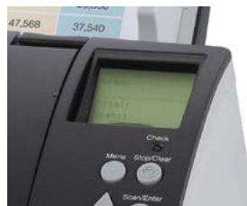
Panel de funcionamiento con pantalla de cristal liquido integrada
