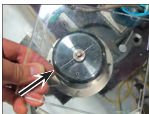
Le fil tourne avec le champ magnétique lorsque l'on tourne l'arbre du capteur de rotation de volant
