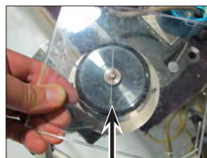
Le fil tourne avec le champ magnétique lorsque l'on tourne l'arbre du capteur de rotation de volant
