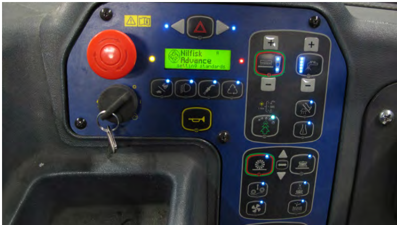
Apparence du tableau de bord en cas de panne du bus CAN
