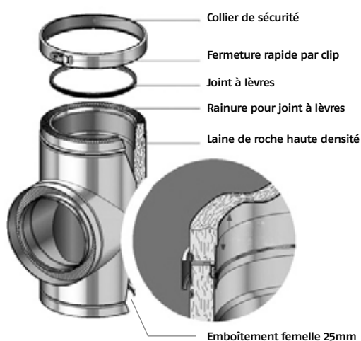
Schéma de montage des joints DOUBLE PAROI
