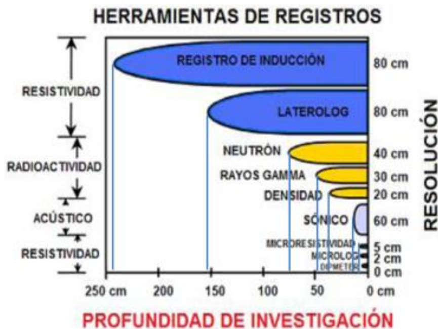
Figura 2.6 Resolución y profundidad de investigación de los registros geofísicos de pozo. (modificado de Torres-Verdin, 2010).
