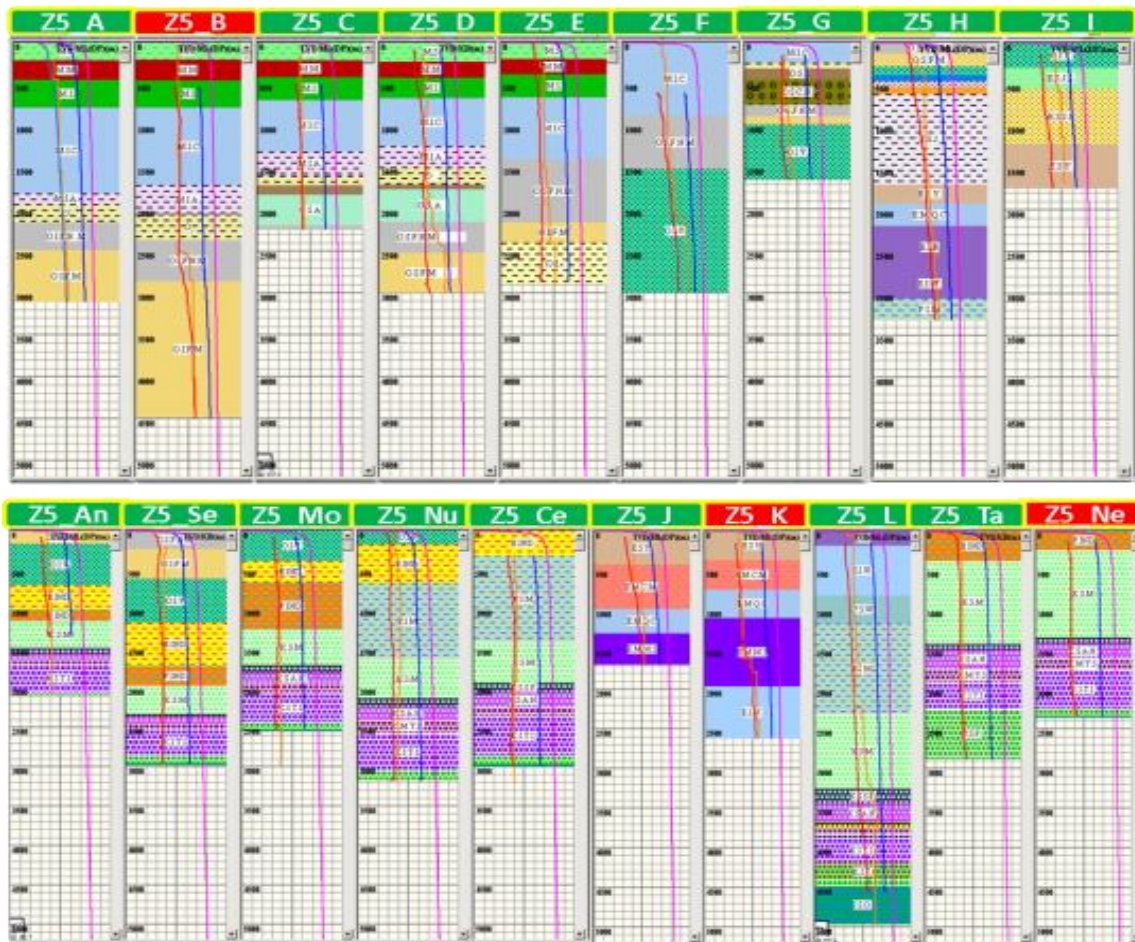
Figura 6.7 Curvas de geopresiones, gradiente de sobrecarga (color rosa), gradiente de presión de poro (color rojo), gradiente de fractura (color azul) y densidad del fluido de perforación (color naranja).
