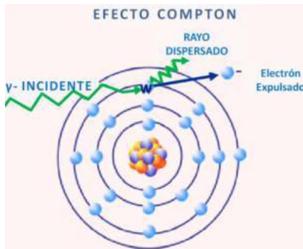
Figura 2.5 Efecto Compton (Cortesía de Schlumberger offshore services, 2008)
