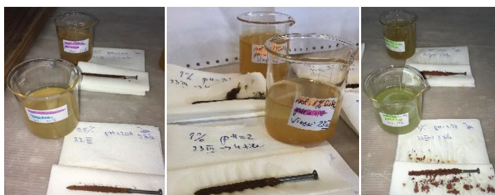
Fig. 4. The amount of copper powder obtained after one day of experiment Rys. 4. Ilość miedzi otrzymanego po jednym dniu eksperymentu
