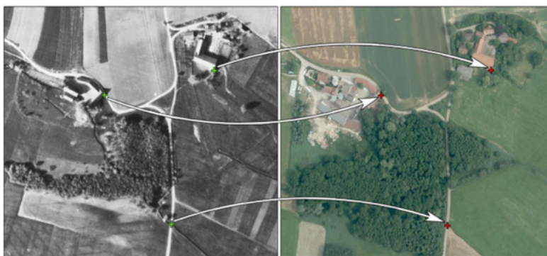
Fig. 7. Identification of terrain objects in the historical and contemporary orthophoto Rys. 7. Identyfikacja obiektów terenowych w ortofotomapy historycznej i współczesnej
