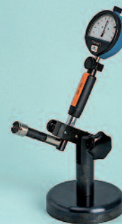
Stativ OD mit Winkelstück, Messdorn OD, Tiefenanschlag, Halter und Messuhr
