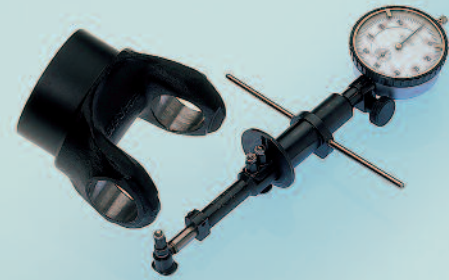
Koax-Messgerät mit Werkstück
