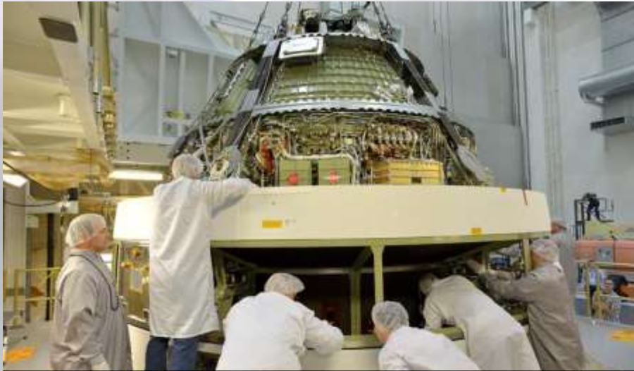
EFT-1 Crew Module/Service Module Mate
