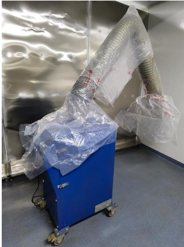
图3-1 生产设备自带除尘器
