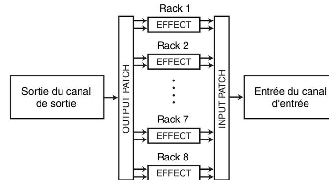
Alternativement, vous pouvez affecter l'entrée et la sortie d'un effet interne à la sortie ou l'entrée d'insertion d'un canal de votre choix (à l'exception d'un canal ST IN), de sorte à insérer l'effet dans ce canal.
