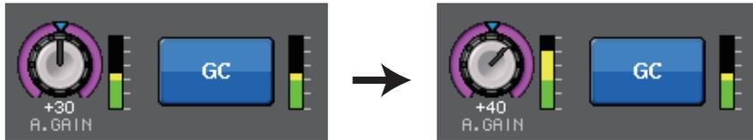
À ce stade, le gain de chaque entrée de signal vers la console de série CL est ajusté selon le réglage du paramètre de gain numérique de la console de série CL.
