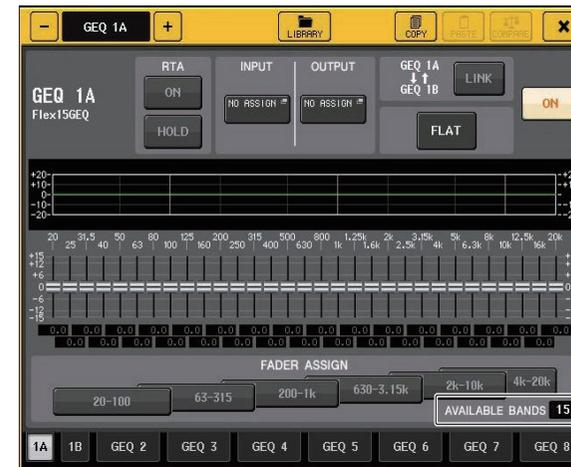
Cette fenêtre est identique à celle du 31BandGEQ, hormis le fait que la zone de paramètre AVAILABLE BANDS (Bandes disponibles) indique le nombre en temps réel de bandes supplémentaires (15 au maximum) pouvant être contrôlées dans le GEQ actuellement sélectionné.
