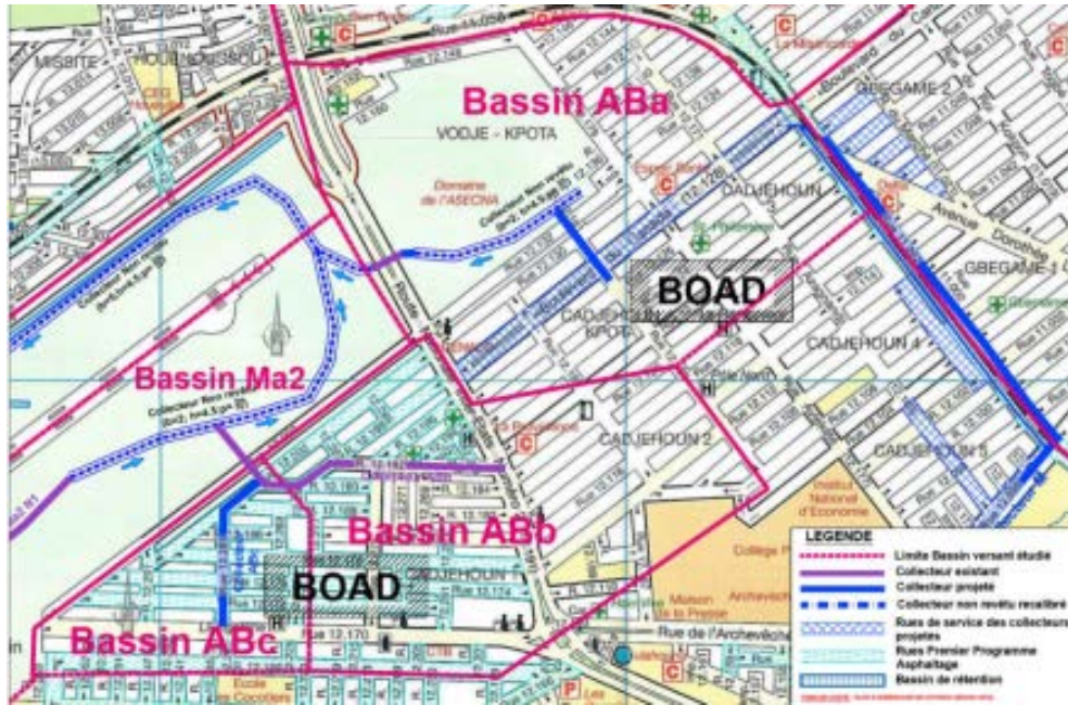
Figure 27 : Vue d'ensemble des aménagements projetés dans les bassins ABa, ABb, et ABc
