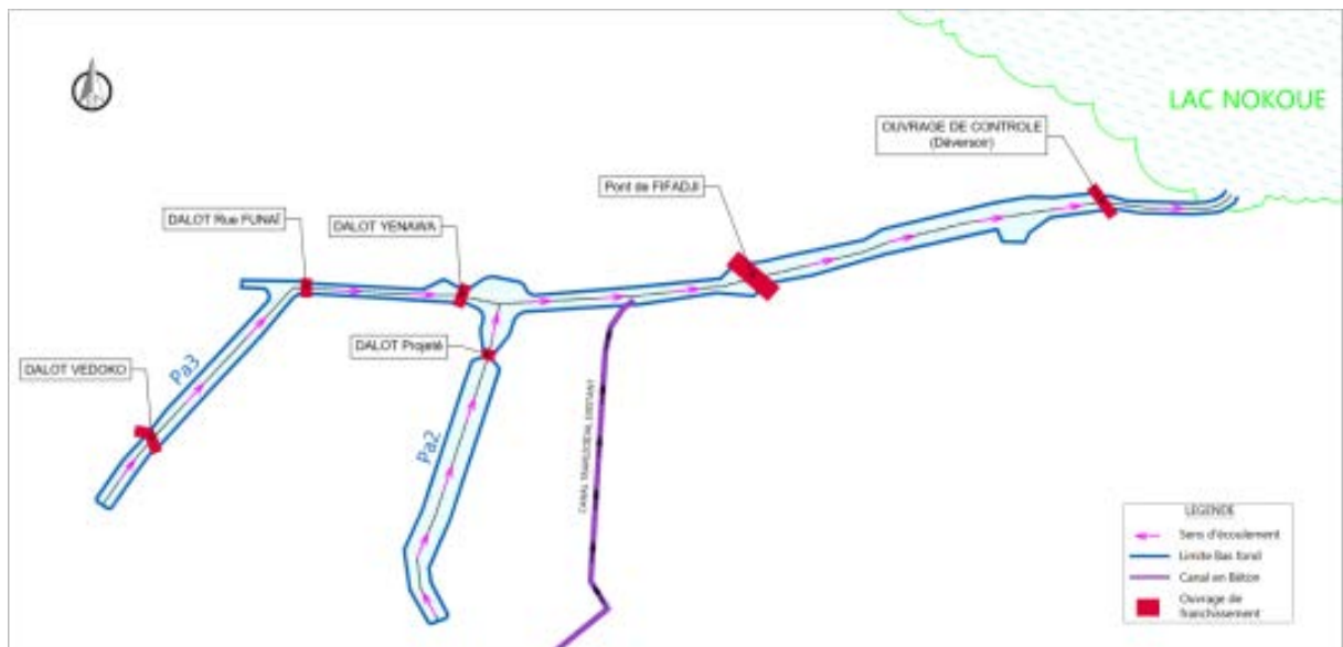
Figure 100 Schéma hydraulique du bassin de rétention Pa
