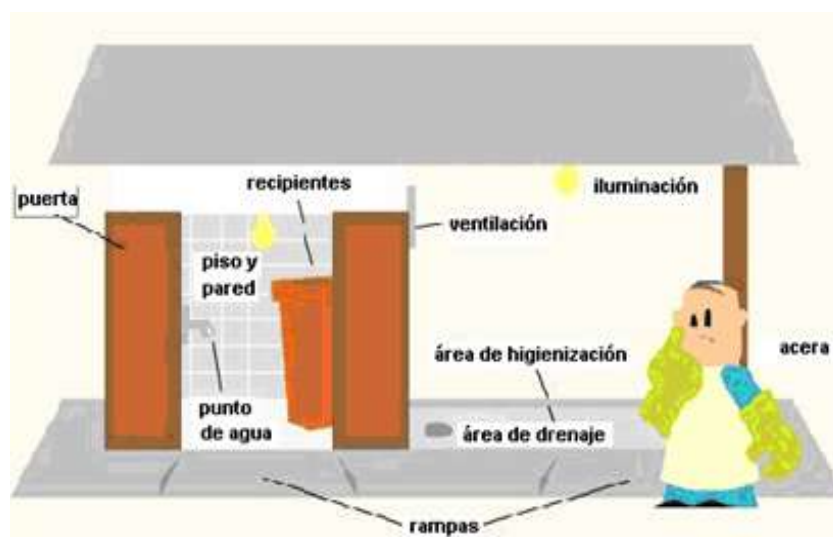
Figura II.5 Esquema tipo de partes más importantes del almacén temporal para residuos peligrosos
