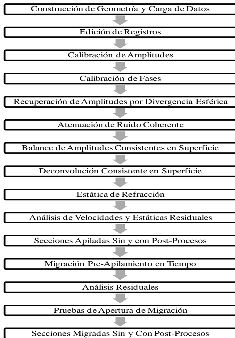
Figura 4.2: Secuencia utilizada en el procesamiento de los datos sísmicos perteneciente al proyecto merge Ceuta – Tomoporo.
