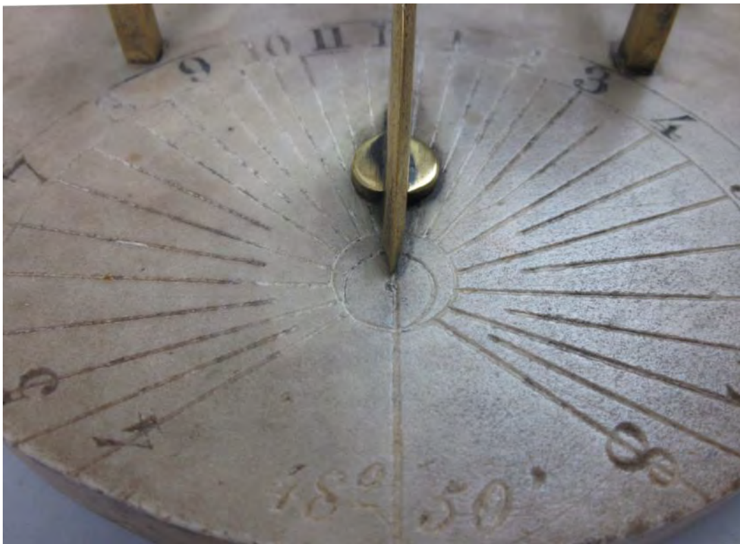
Reloj de sol horizontal calculado para la latitud de Montreal: 48^{\circ} 50' .
