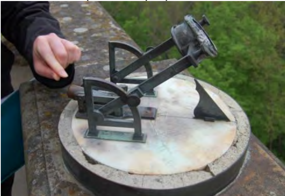
Reloj de sol horizontal, calculado para 48^{\circ} 12' , latitud de Viena (Austria).
