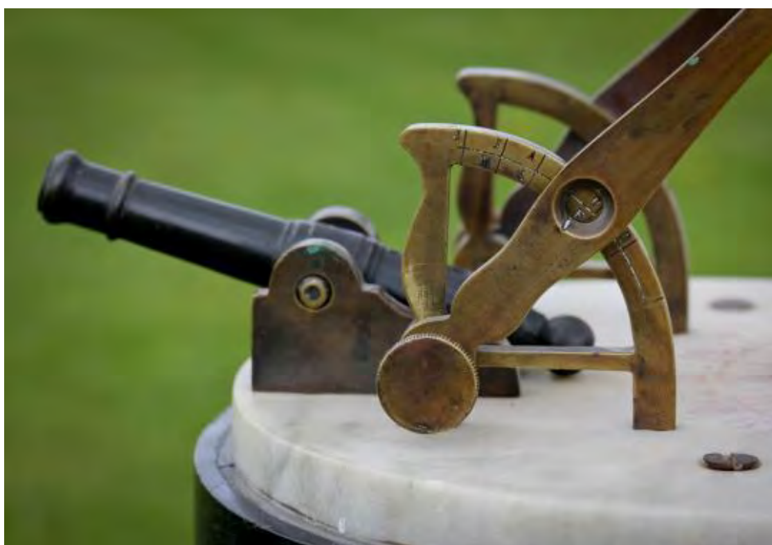
Falsa escala con las iniciales de los meses grabadas. El brazo tapa el mes de enero.
