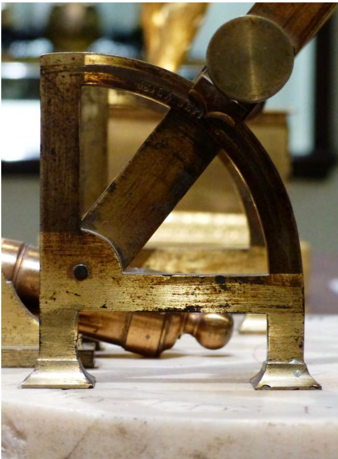
Soporte izquierdo y brazo recto de la lente. Pestaña y escala de altura del sol.
