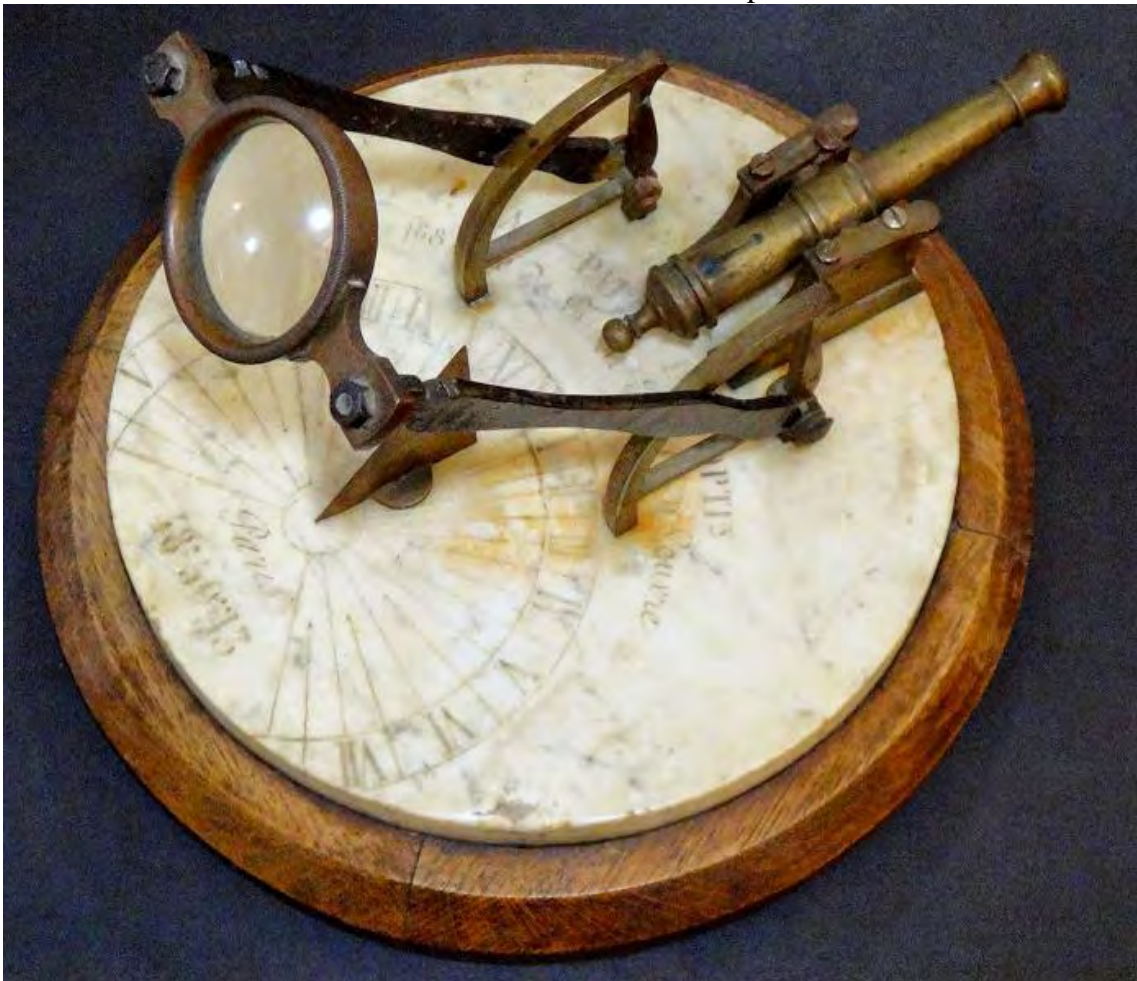
Reloj de sol horizontal, calculado para la latitud de Paris: 48^{\circ} 50' 13'' .
