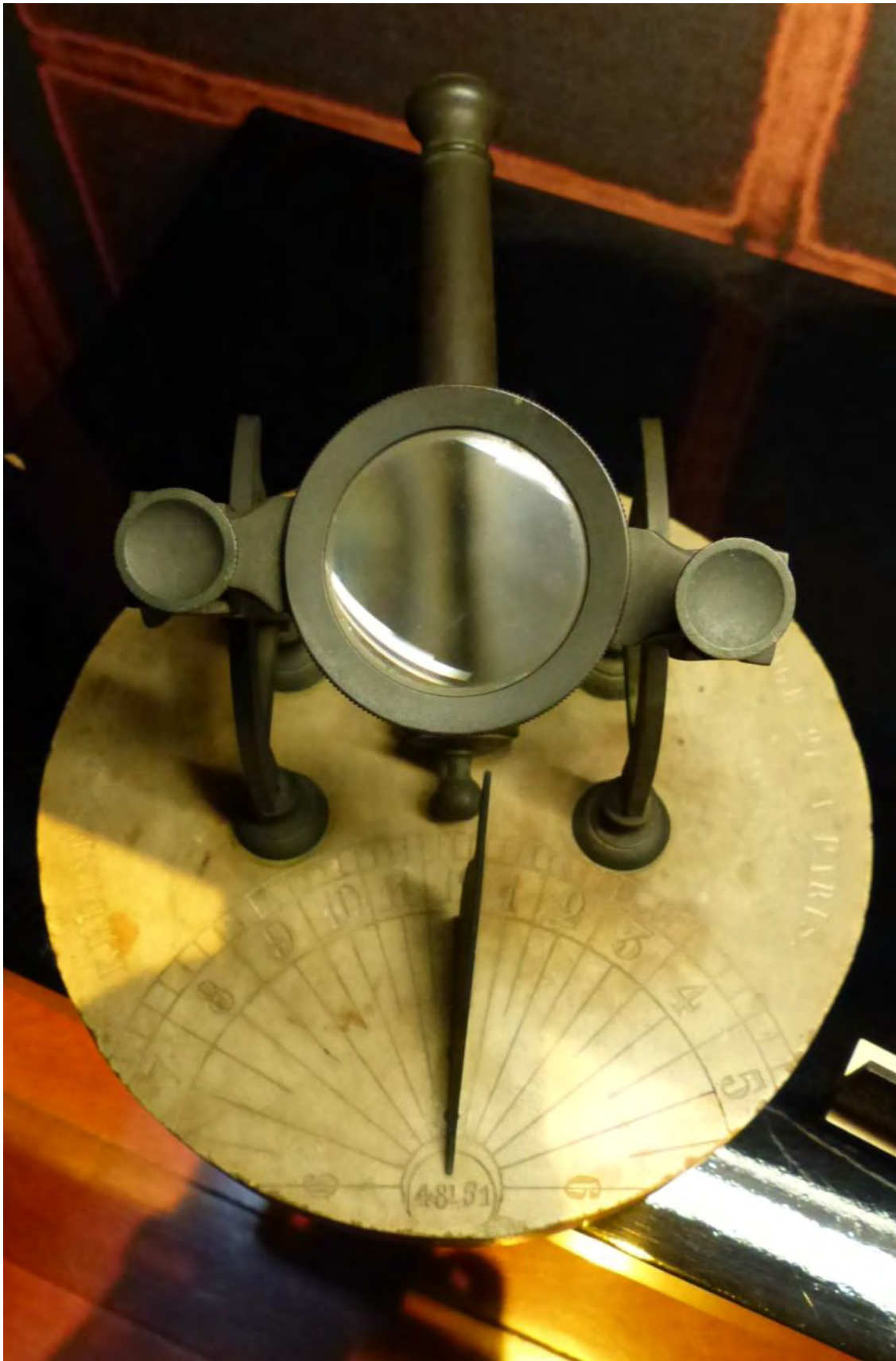
El gnomon está doblado hacia la derecha. Marca horas, medias y cuartos.
