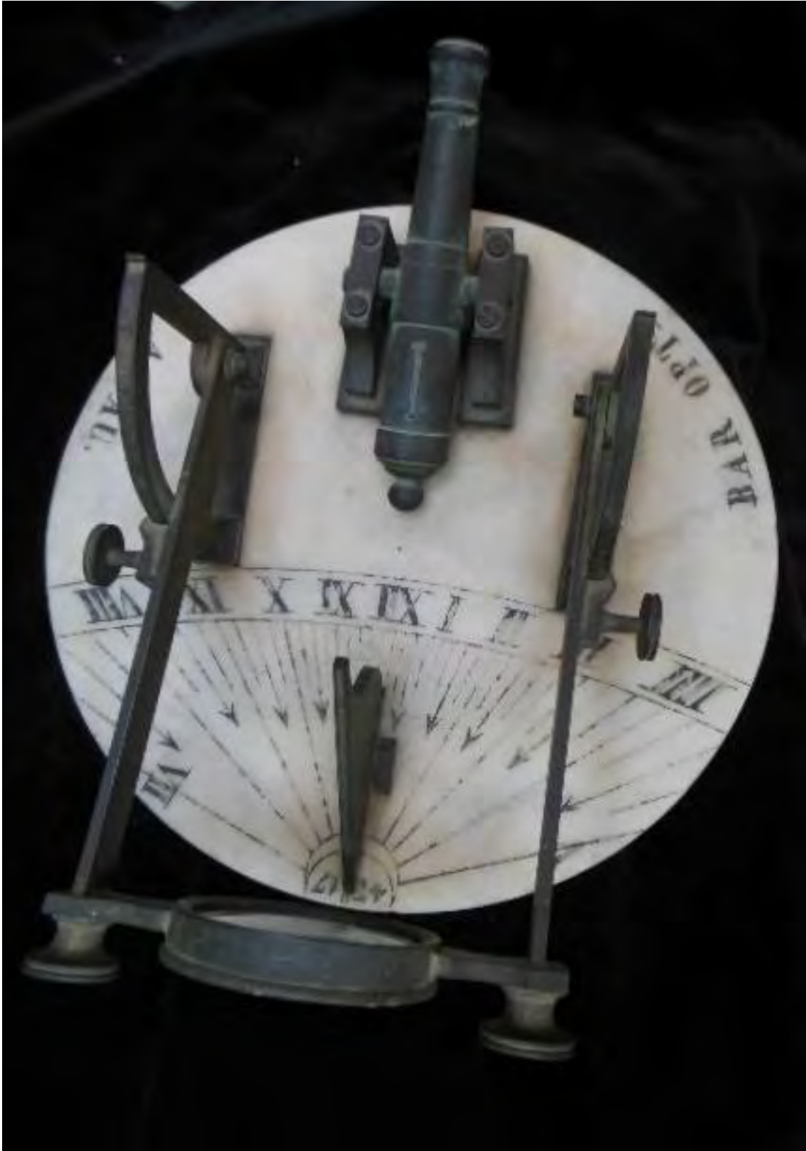
Reloj de sol horizontal, calculado para 43^{\circ} 17' , latitud de Pau.
