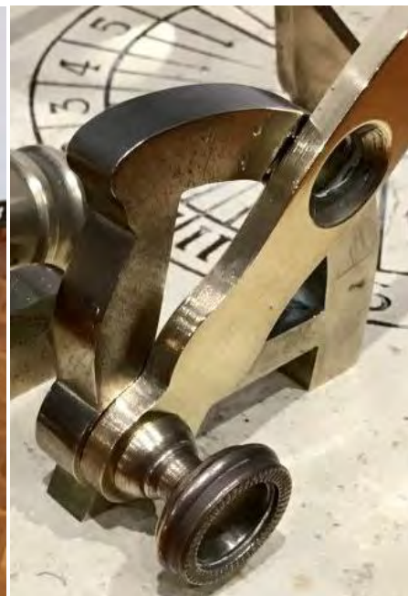
Tornillos de sujeción: gualderas (2, 2), soportes (2, 2), gnomon (1).
