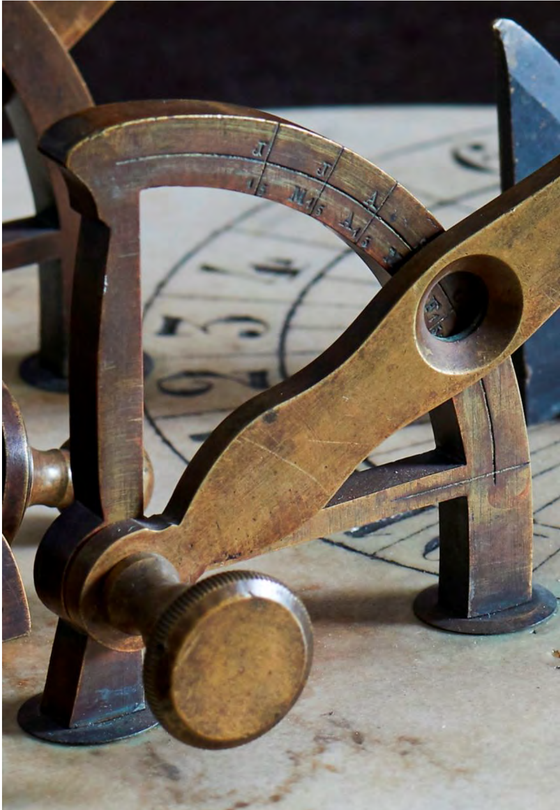
Soporte izquierdo. Escala de altura del sol.
