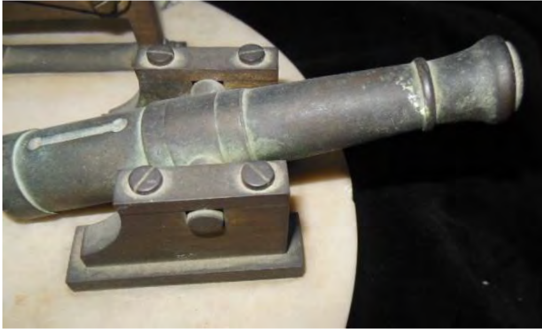
Cañón desmontable. Gualderas con sobremuñoneras rectas de apertura horizontal.
