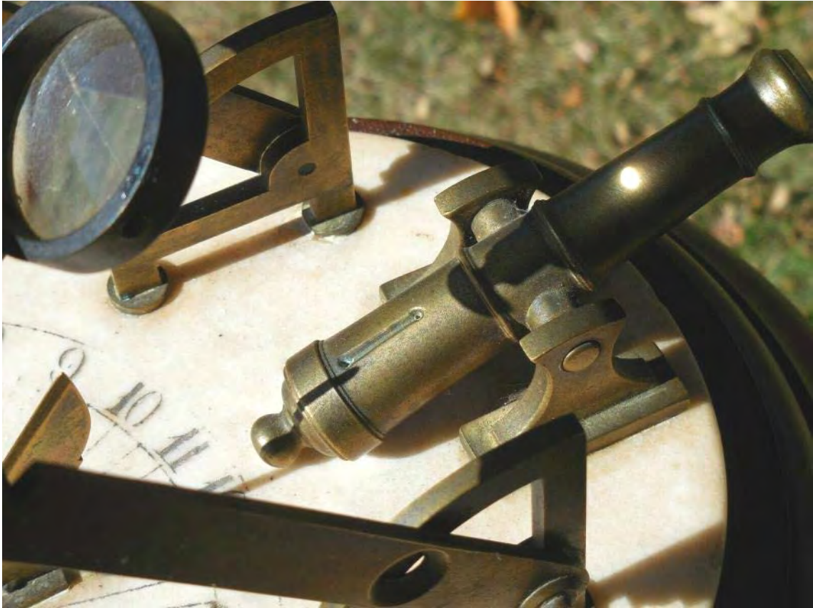
La lente va unida al travesaño que une los dos brazos.
