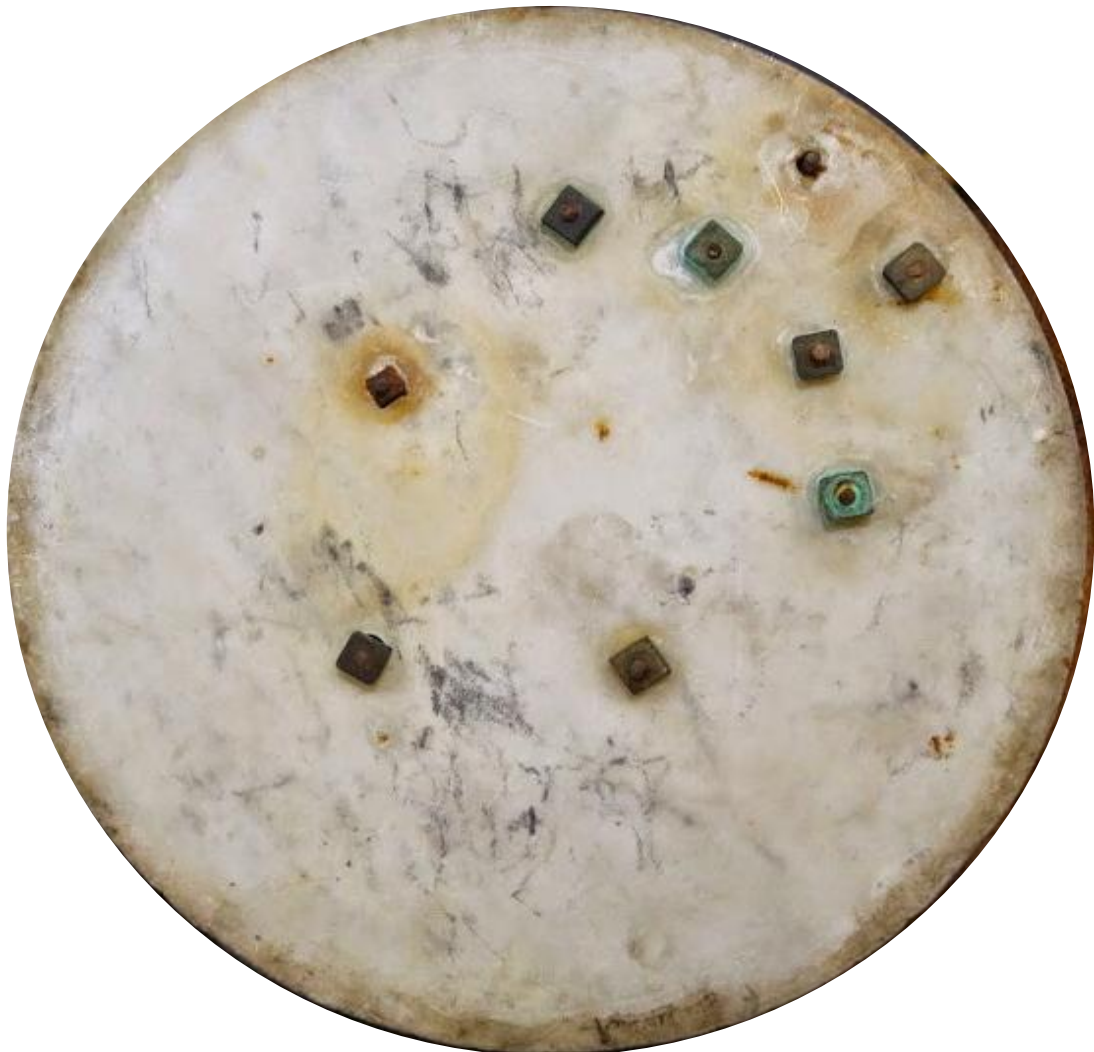
Tornillos de sujeción de las piezas metálicas: cañón (2+2), soportes (2+2), gnomon (1).
