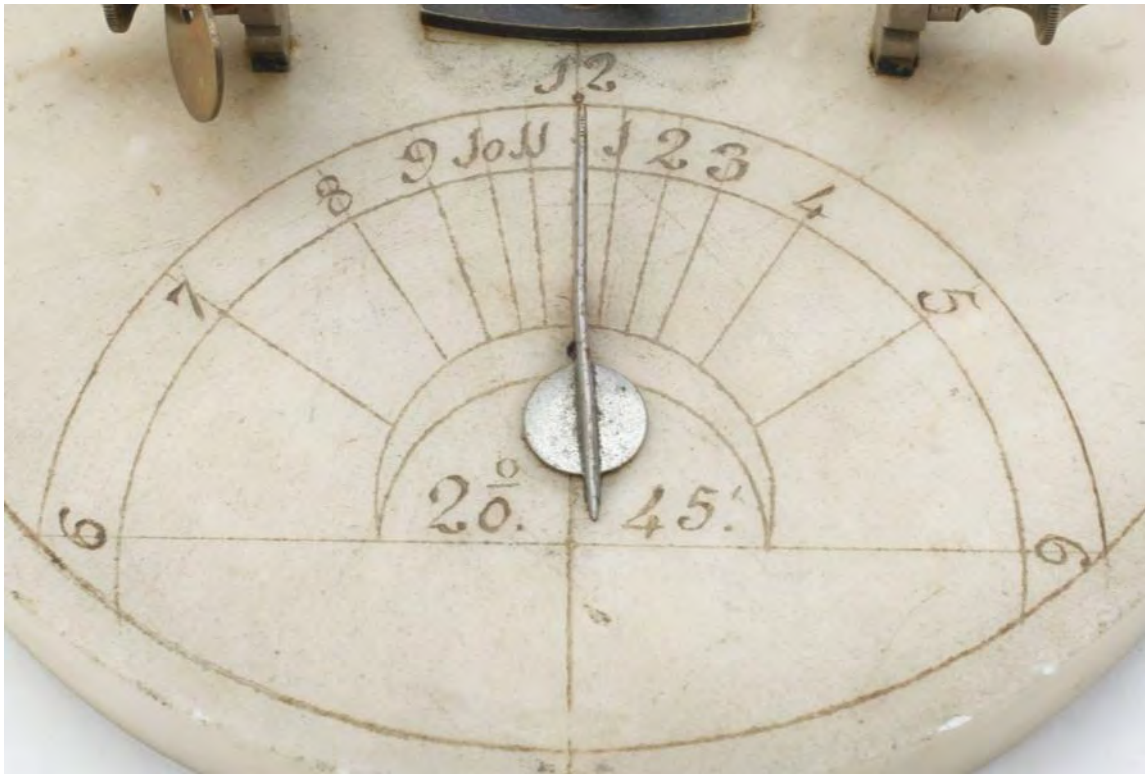
El gnomon no coincide con el foco del reloj de sol.
