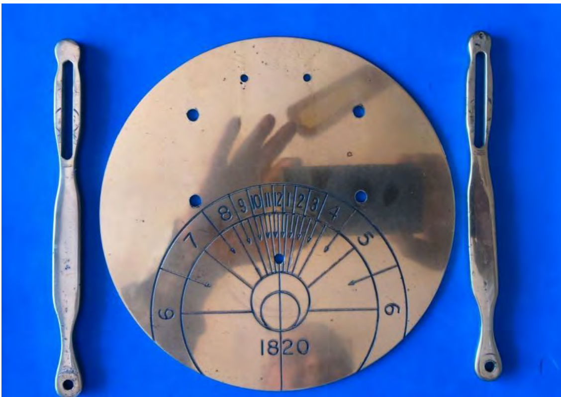
Despiece: base metálica y brazos de la lente.
