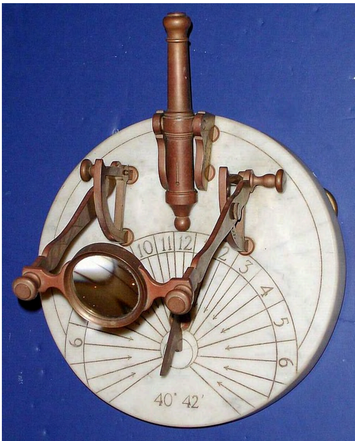
Reloj de sol calculado para 40^{\circ} 42' , latitud de Nueva York.
