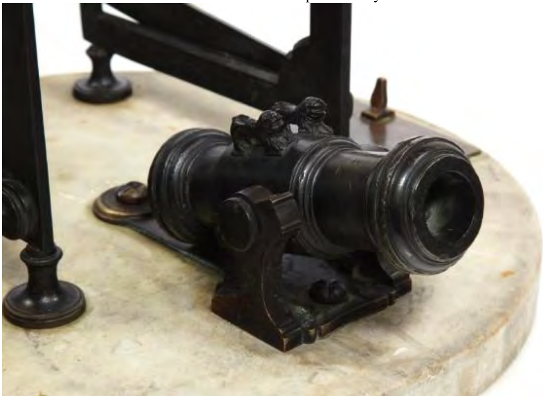
Las orejas del mortero tienen forma de leones andantes. Cañón desmontable. Gualderas con sobremuñonera semicilíndricas.
