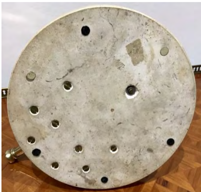
Tornillos de sujeción: gualderas (2, 2), soportes (2, 2), gnomon (1).
