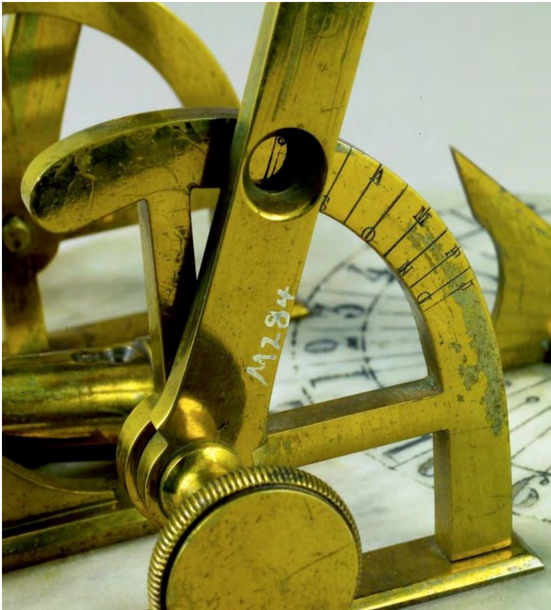
Detalle. Escala de altura del sol. El ángulo de enero es menor que el de diciembre.
