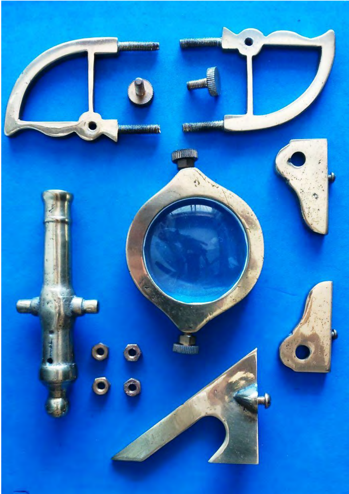
Despiece: soportes, tornillos de los brazos de la lente, cañón, aro y lente plano convexa, gualderas, tuercas de los soportes de la lente y gnomon.
