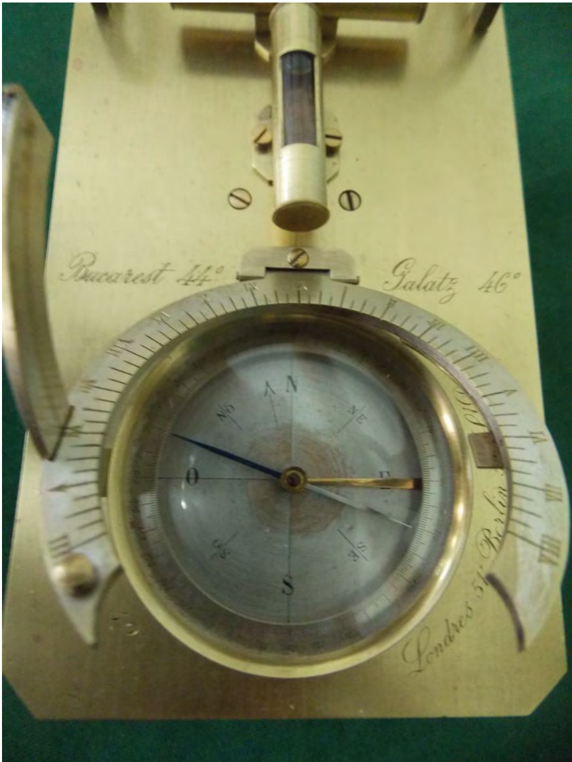
Detalle: nivel de burbuja, brújula y reloj de sol ecuatorial universal.
