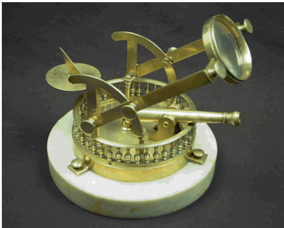
Diámetro de la base de mármol: 19 cm. Reloj horizontal, numerado en arábigos, horas de 6 de la mañana a 6 de la tarde, con líneas de medias y de cuartos. El oído del cañón no se encuentra en el eje de giro de la lente. Inscripción en la chapa circular del reloj de sol: "Liard Paris". Ca. 1900.
