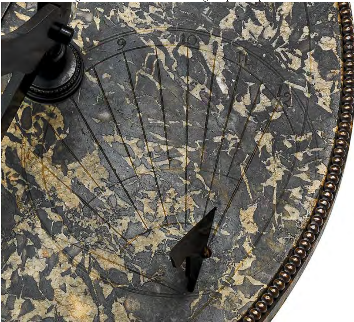
Reloj de sol de mañana: marca desde las seis de la mañana hasta el mediodía.
