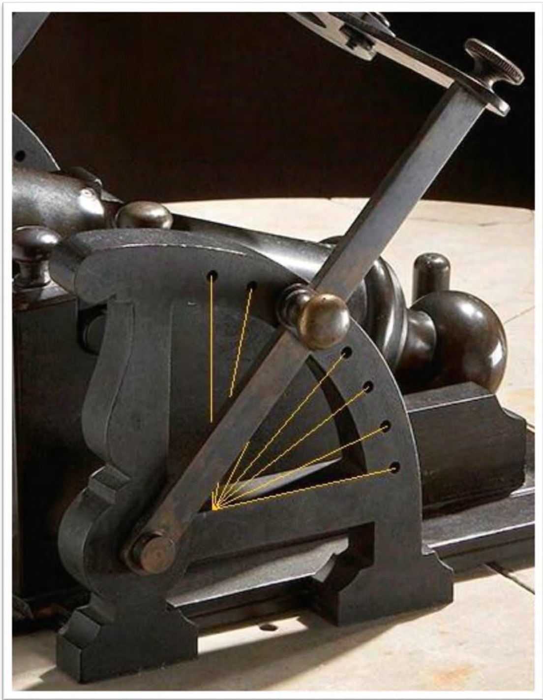
Cuadrante izquierdo de la lente. Escala de altura del sol.
