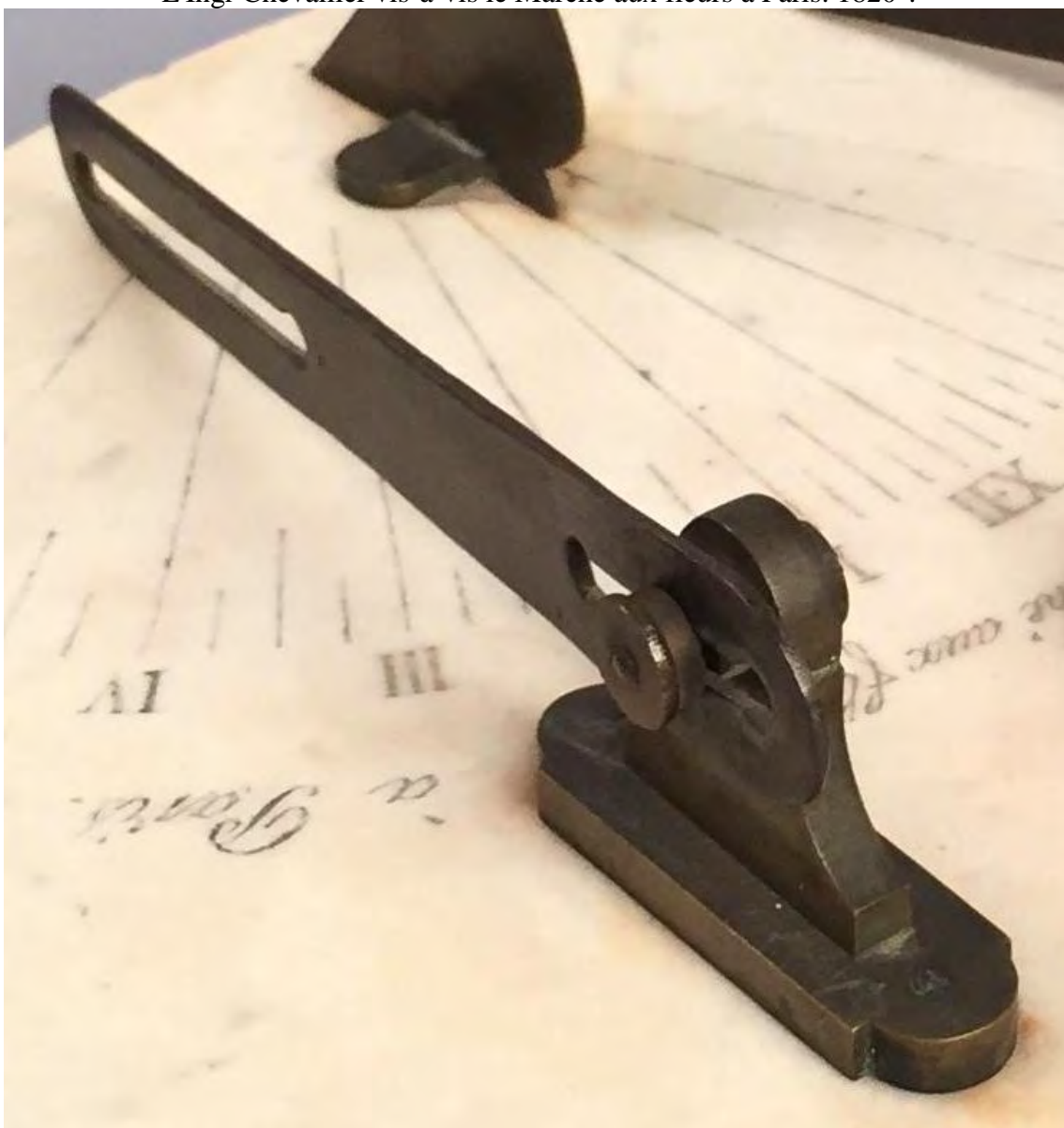
Ranuras en los brazos de la lente para facilitar el enfoque en el oído del cañón.
