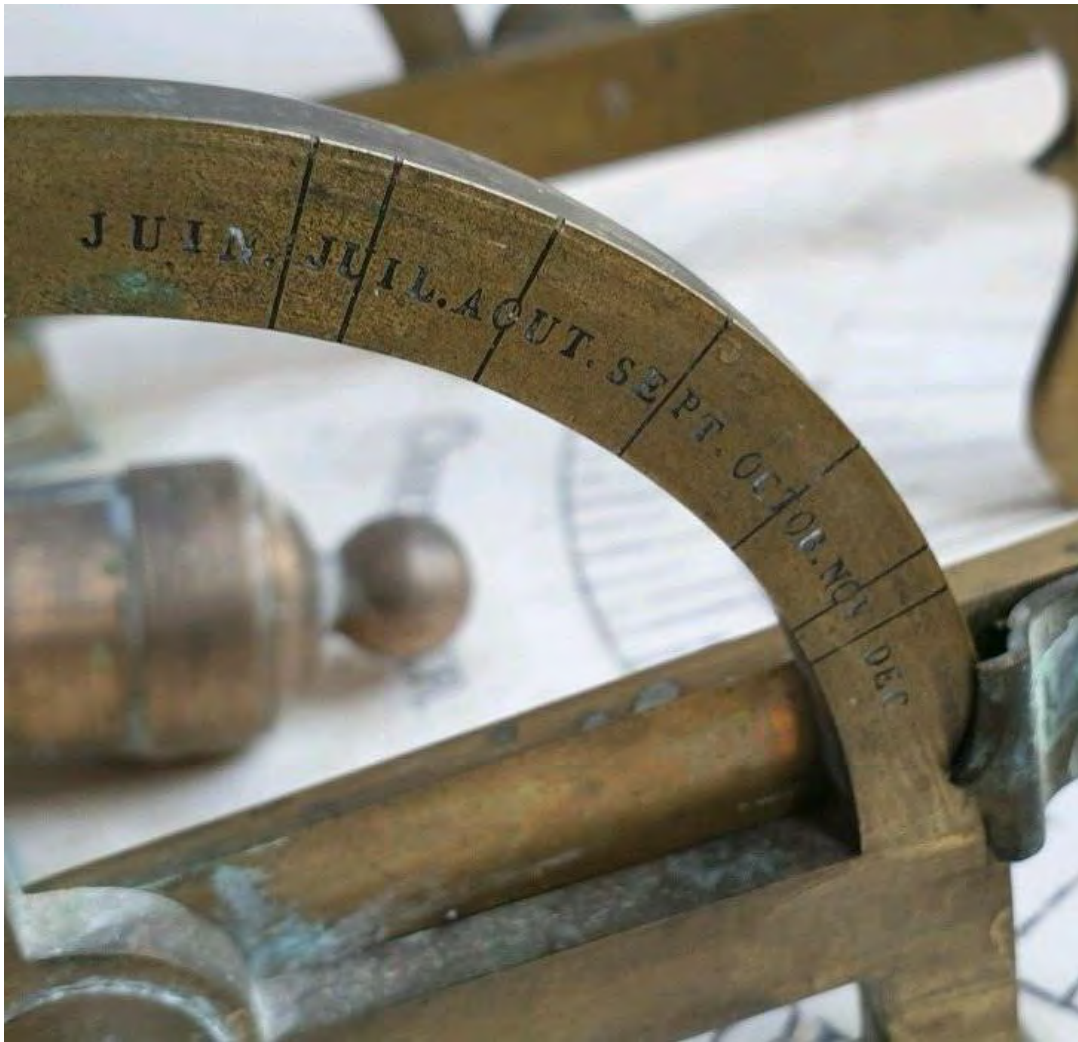
Pestaña. Escala de altura del sol. Nombres de los meses: JUIN, JUIL,...
