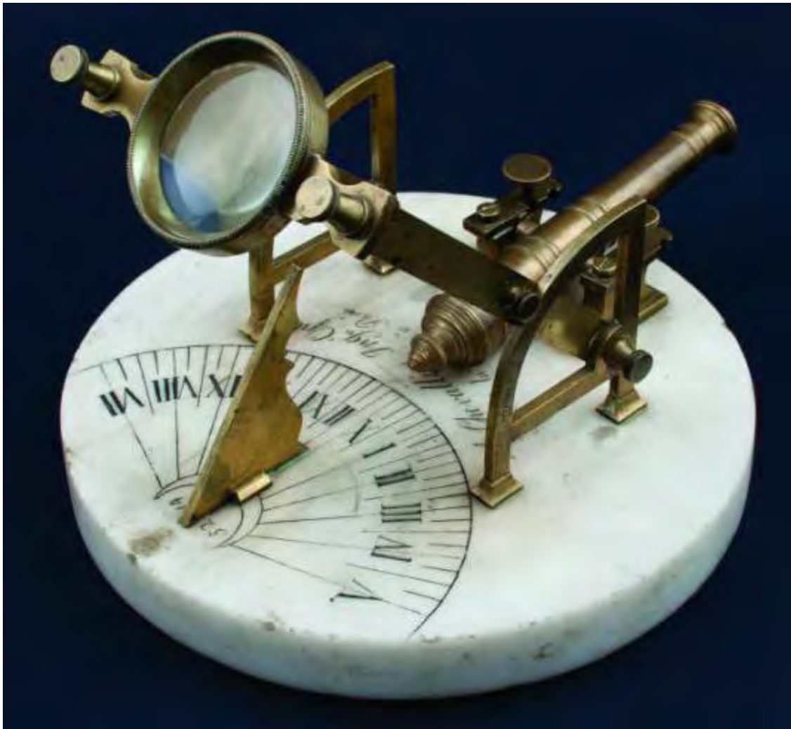
Gnomon triangular de doble arista y pie rectangular.
