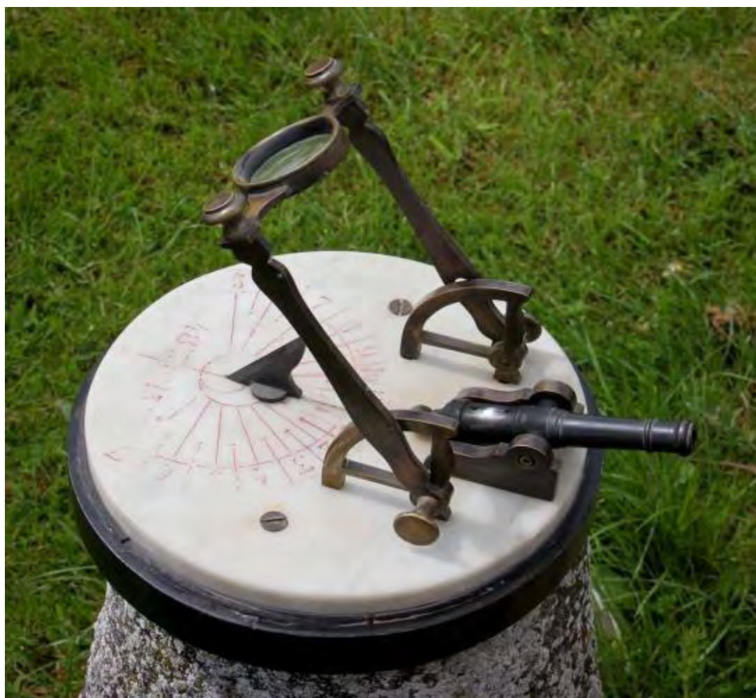
Calculado para la latitud de Paris: 48^{\circ} 50' 13'' . Diámetro de la base: 20 cm.
