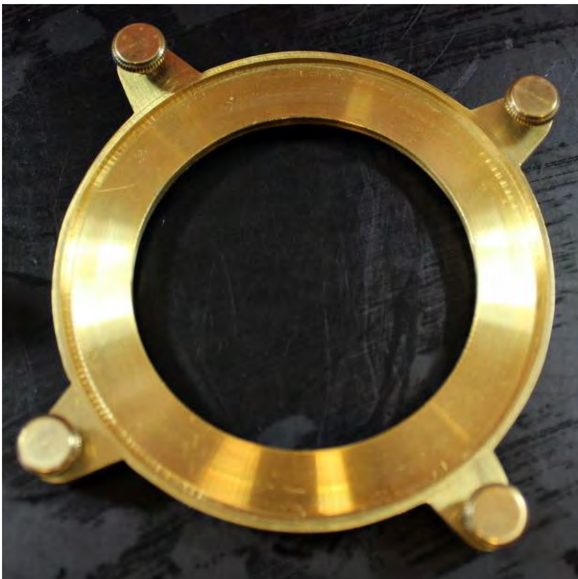
Base circular de latón con cuatro pies graduables.
