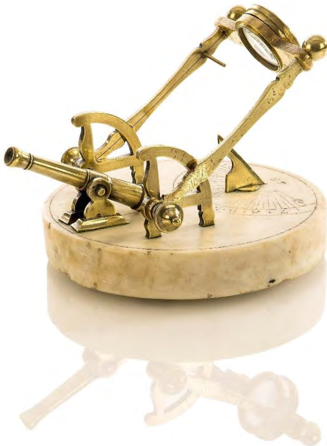
El mismo cañón meridiano de las dos páginas anteriores. Latitud: 45°. Después de la limpieza, le han intercambiado los brazos de la lente.
