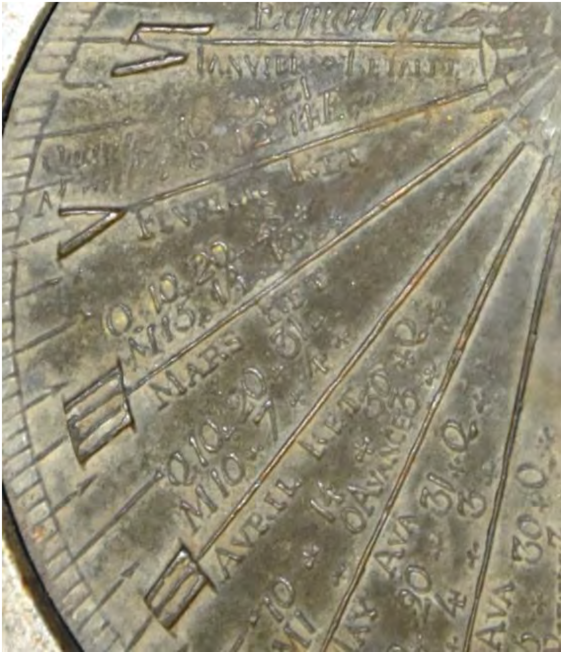
Valores de la "Equation Du Soleil" escritos en el interior de los sectores horarios.
