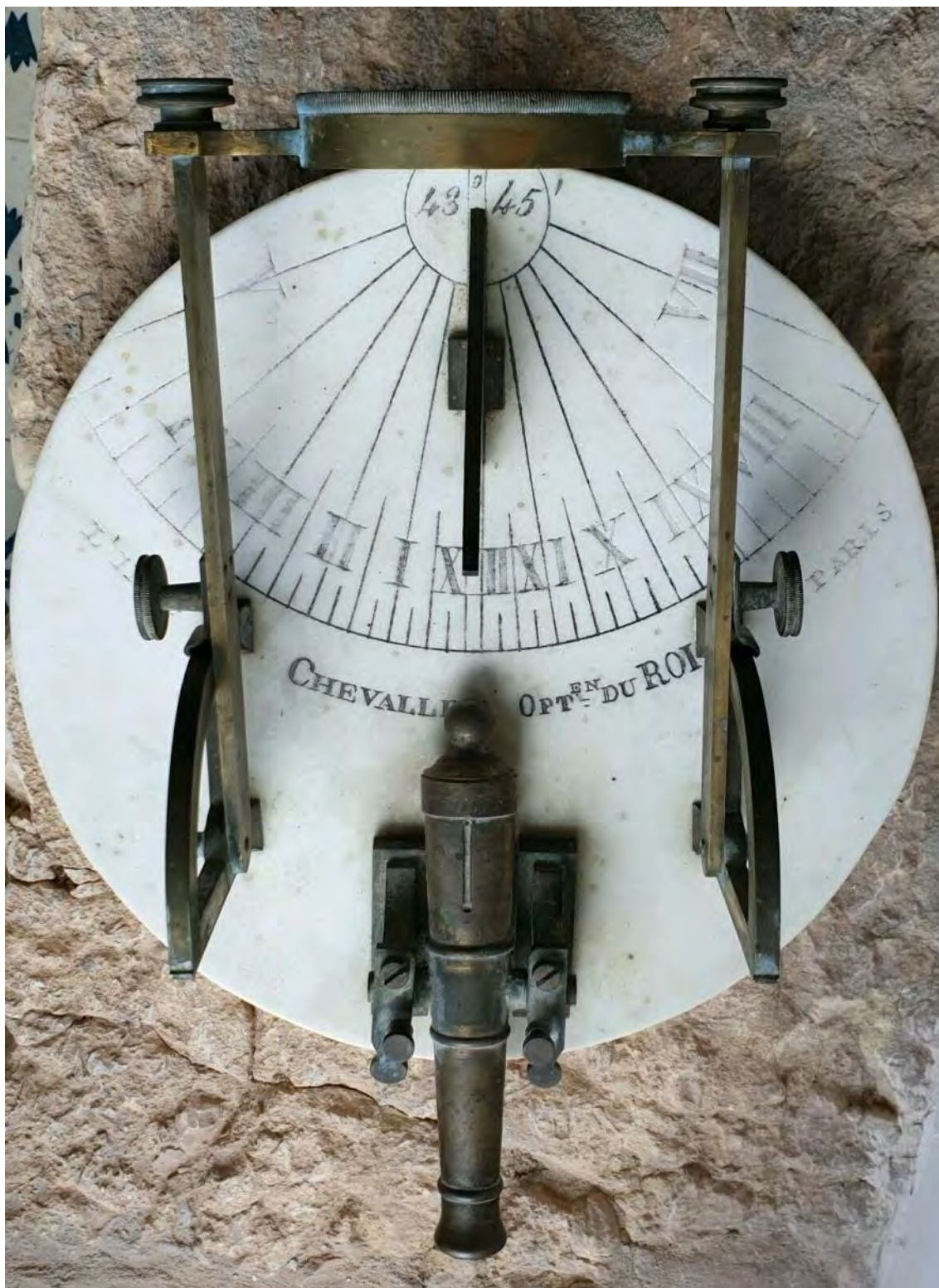
Gnomon triangular de doble arista y pie rectangular.
