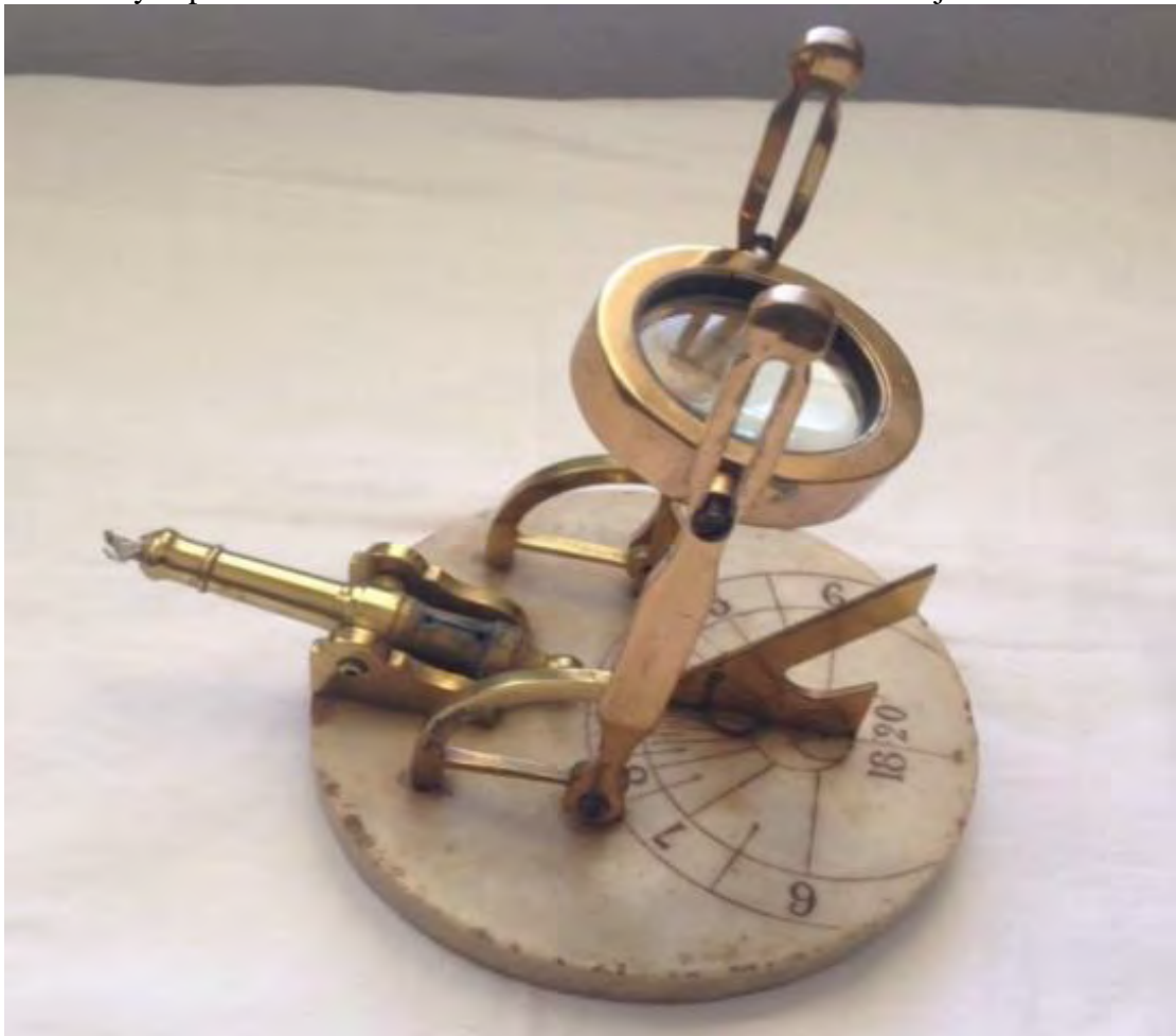
Gnomon y soportes colocados al revés.
