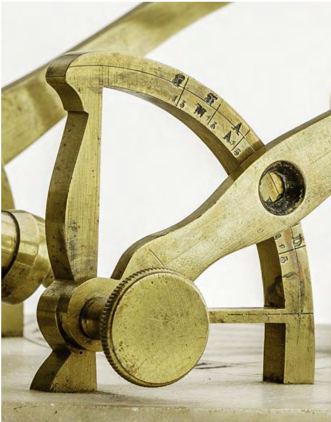
Detalle. Soporte izquierdo de la lente. Escala de altura del sol.
