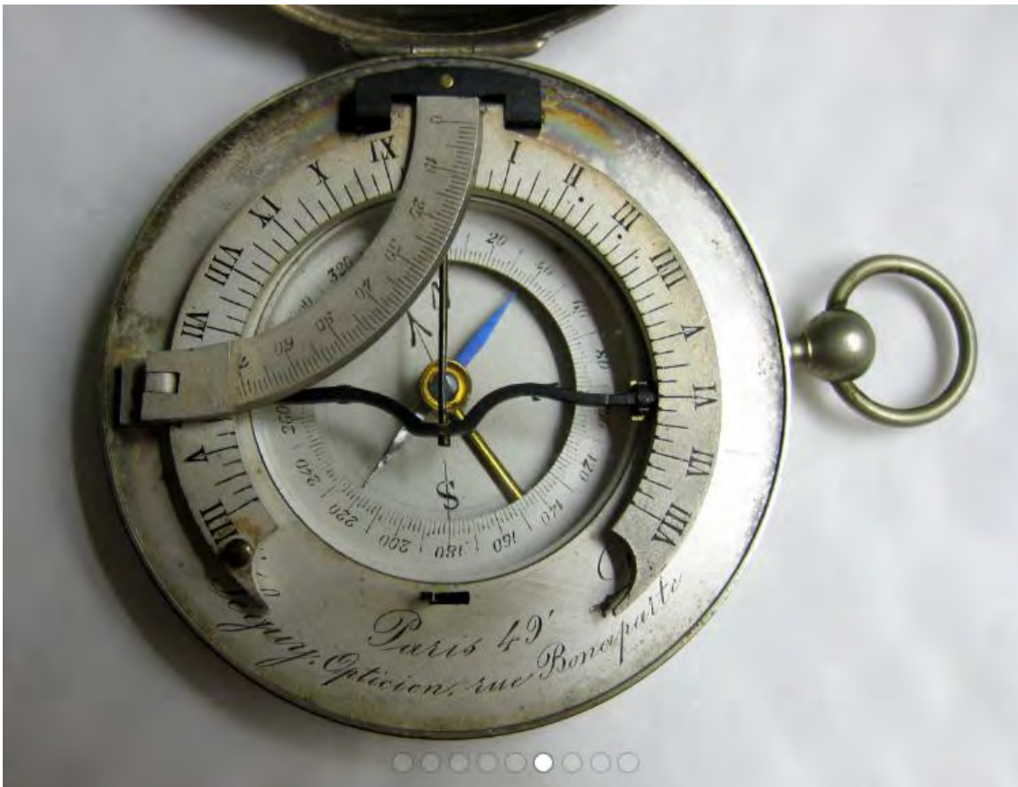
Reloj de sol ecuatorial universal de bolsillo firmado por Séguy en rue Bonaparte.
