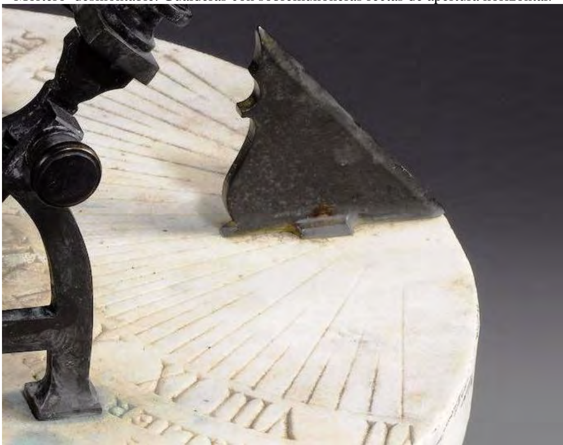
El gnomon está mal colocado. ¿Repuesto?
