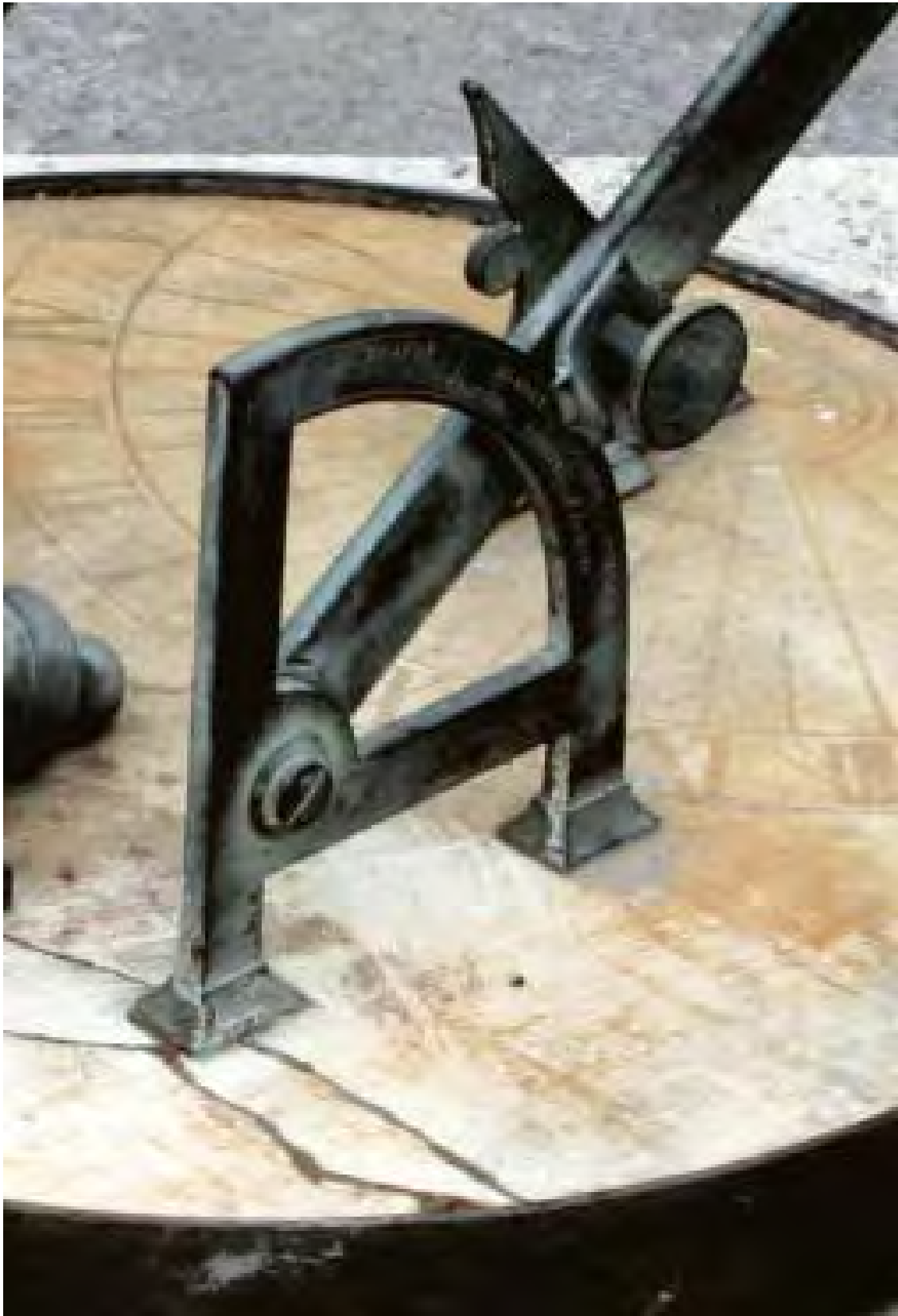
Soporte izquierdo. Escala de altura del sol con los meses en francés. Pies rectangulares.
