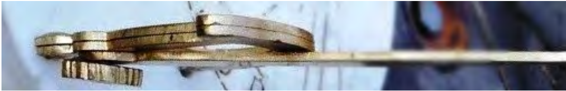
Los soportes de la lente están contruidos con doble chapa.
