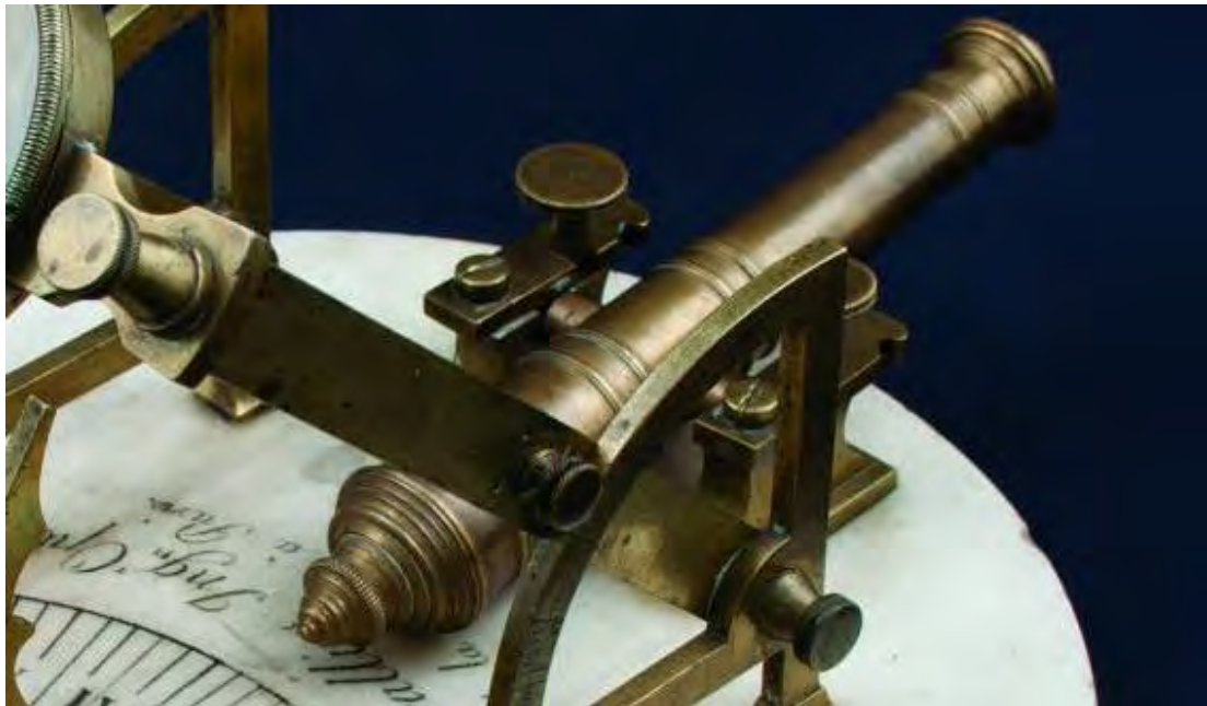
Cañón desmontable. Gualderas con sobremuñoneras rectas de apertura horizontal.
