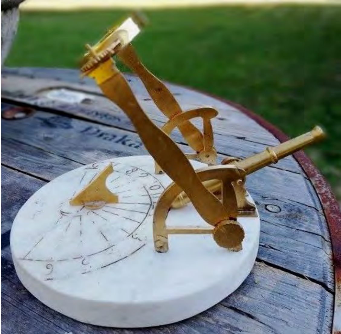
Los soportes de la lente están contruidos con doble chapa.
