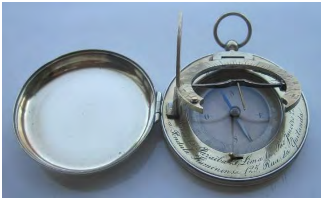
Reloj de sol de bolsillo francés A Pendula Fluminense.
