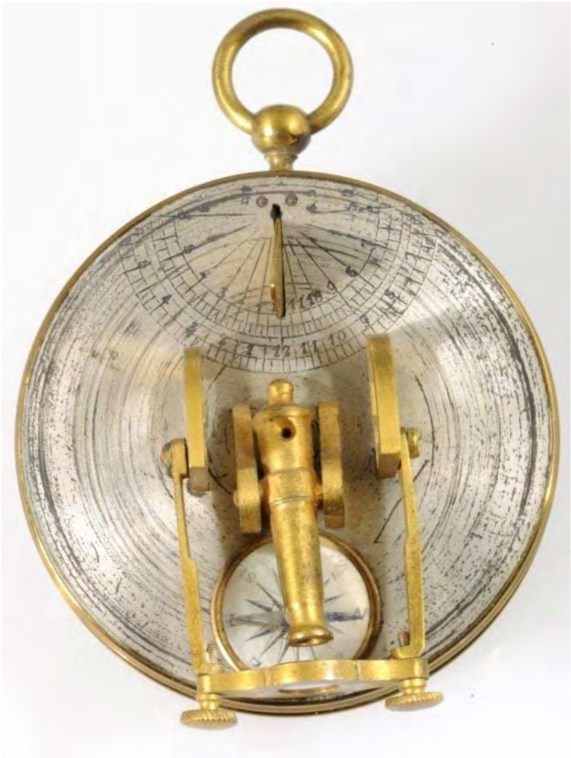
Reloj de sol horizontal calculado para dos latitudes: 46^\circ y 49^\circ .
