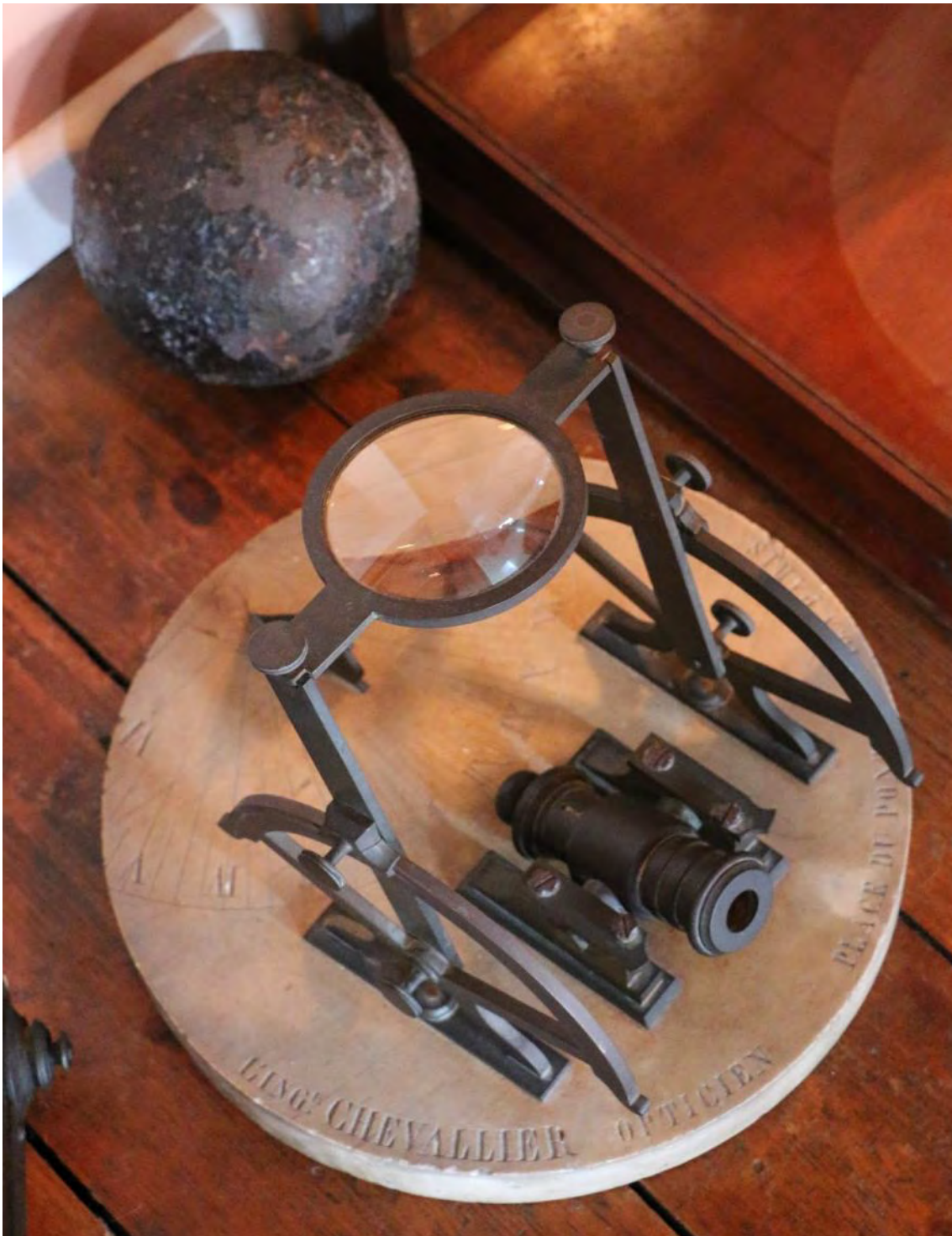
Mortero desmontable. Gualderas con sobremuñeras de apertura horizontal. Inscripción: "L'ING. CHEVALLIER OPTICIEN PLACE DU PONT NEUF 15 A PARIS". Autor: Jean Gabriel Augustin Chevallier.
