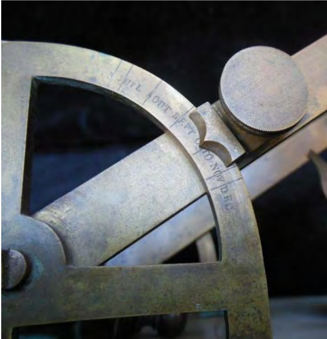
Detalle. Pestaña marcadora y escala de altura del sol.
