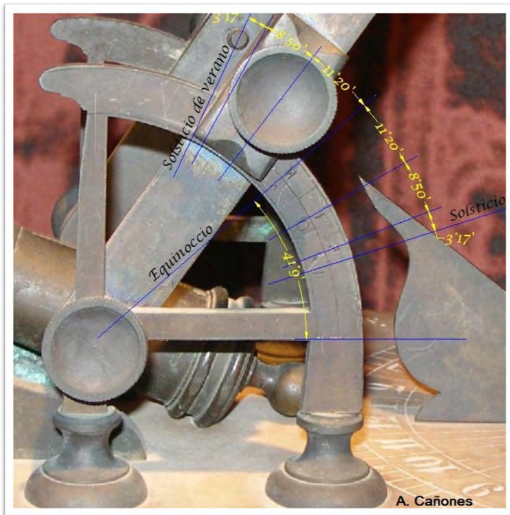
Altura de sol. Escala calculada una latitud de 48^{\circ} 51' (latitud de Paris).
