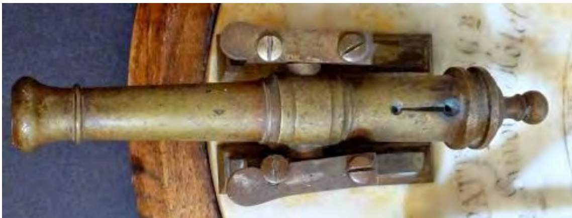
Cañón desmontable. Gualderas con sobremuñoneras rectas de apertura horizontal.
