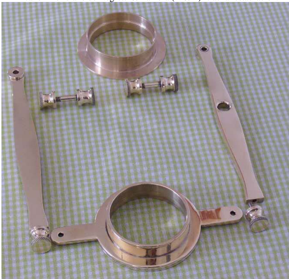
Reconstrucción de la lente, brazos y tornillos del soporte.
