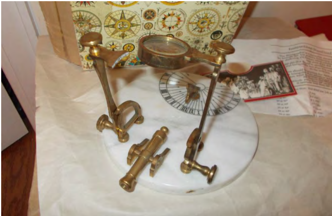
La pletina de la lente está partida y la lente colocada al revés.
