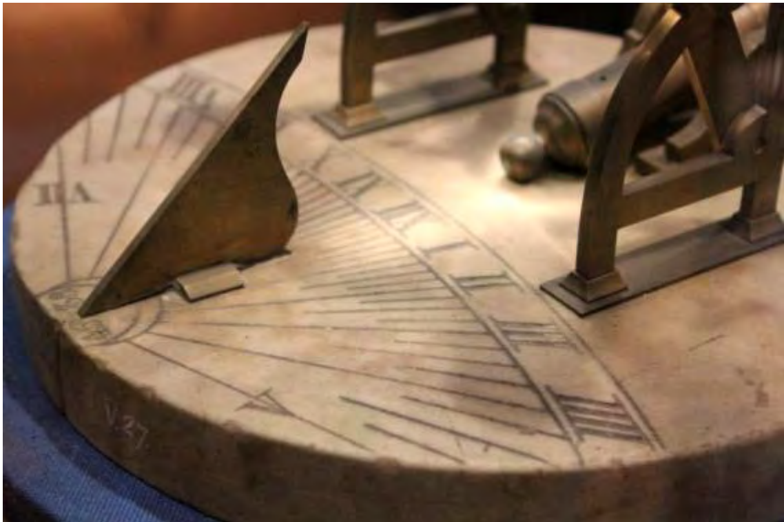
Gnomon triangular de doble arista y pie rectangular.
