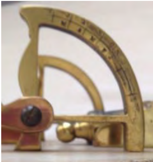
Gnomon y soportes colocados al revés.
