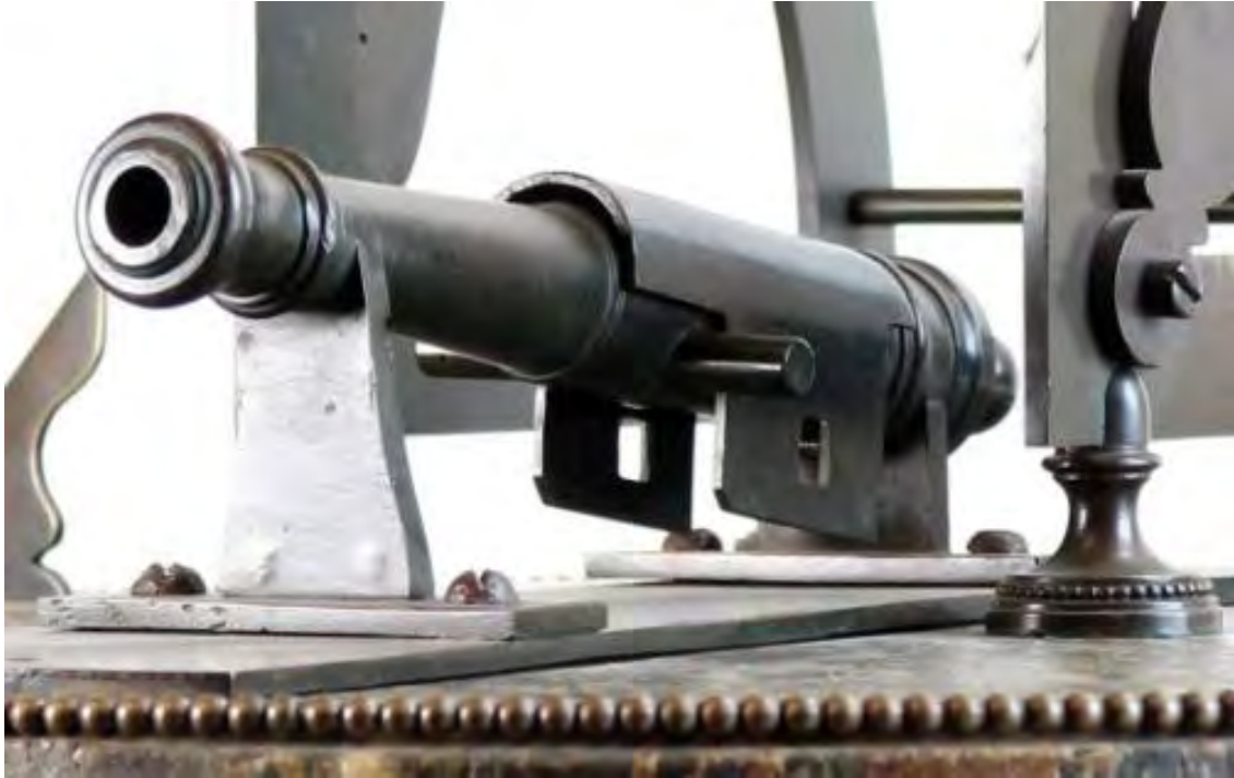
Cañón sin gualderas unido a la base rectangular por dos piezas soldadas.
