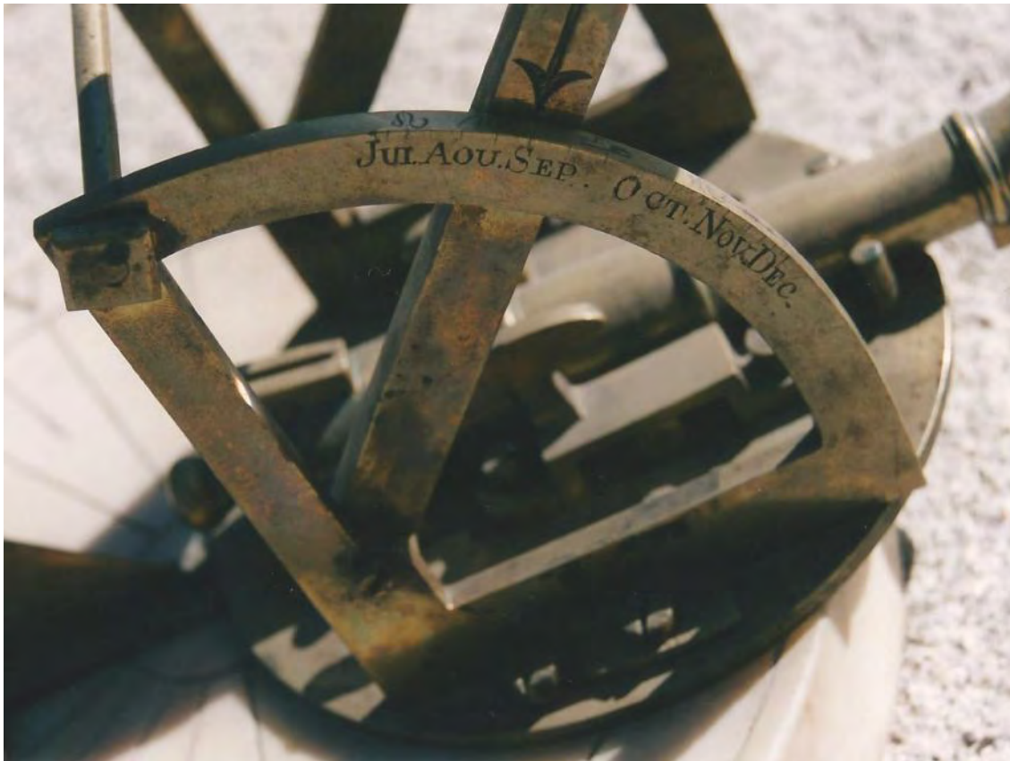
Brazos de la lente rectos que gran por el interior de los soportes.
