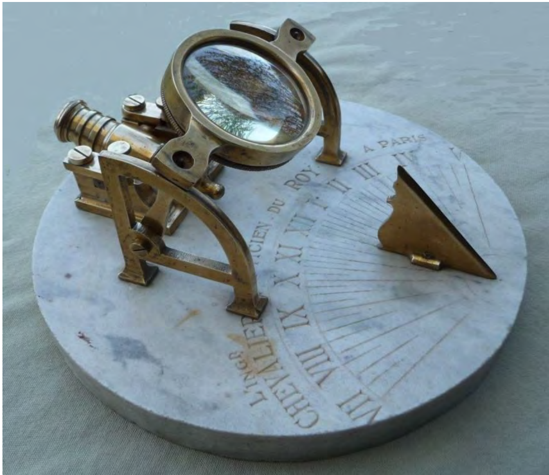
Gnomon triangular de doble arista y pie rectangular.
