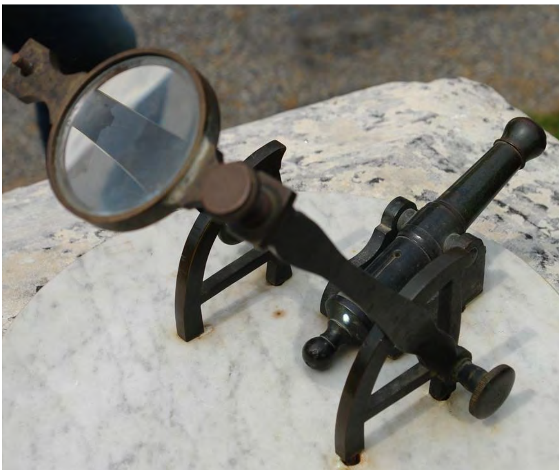
Piezas originales: lente, brazos, soportes y cañón con su cureña.
