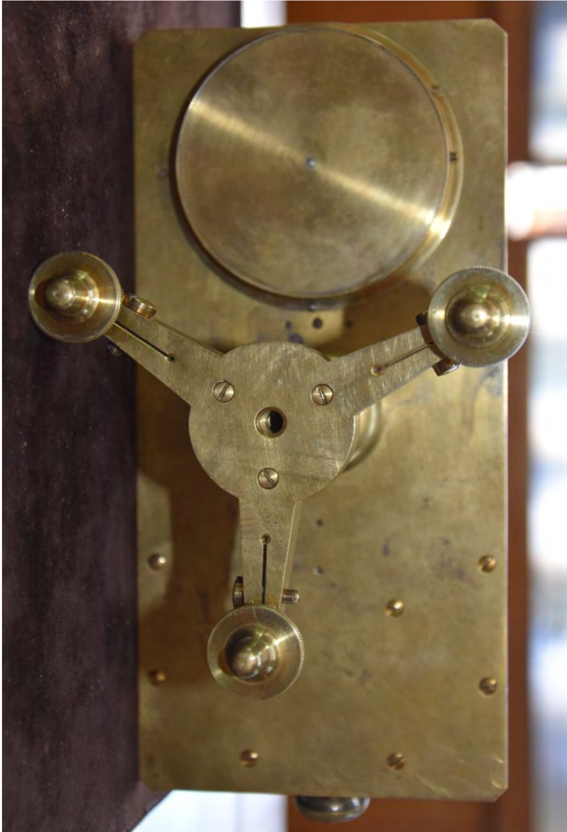
Vista inferior: los tres pies graduables, cuatro tornillos de fijación del cañón, cuatro tornillos de fijación de los soportes de la lente y caja cilíndrica de la brújula.
