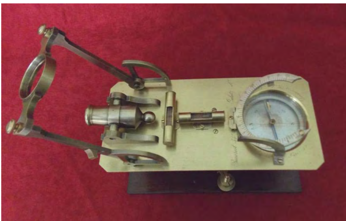
Méridien à mortier con reloj ecuatorial universal, brújula y dos niveles de burbuja.
