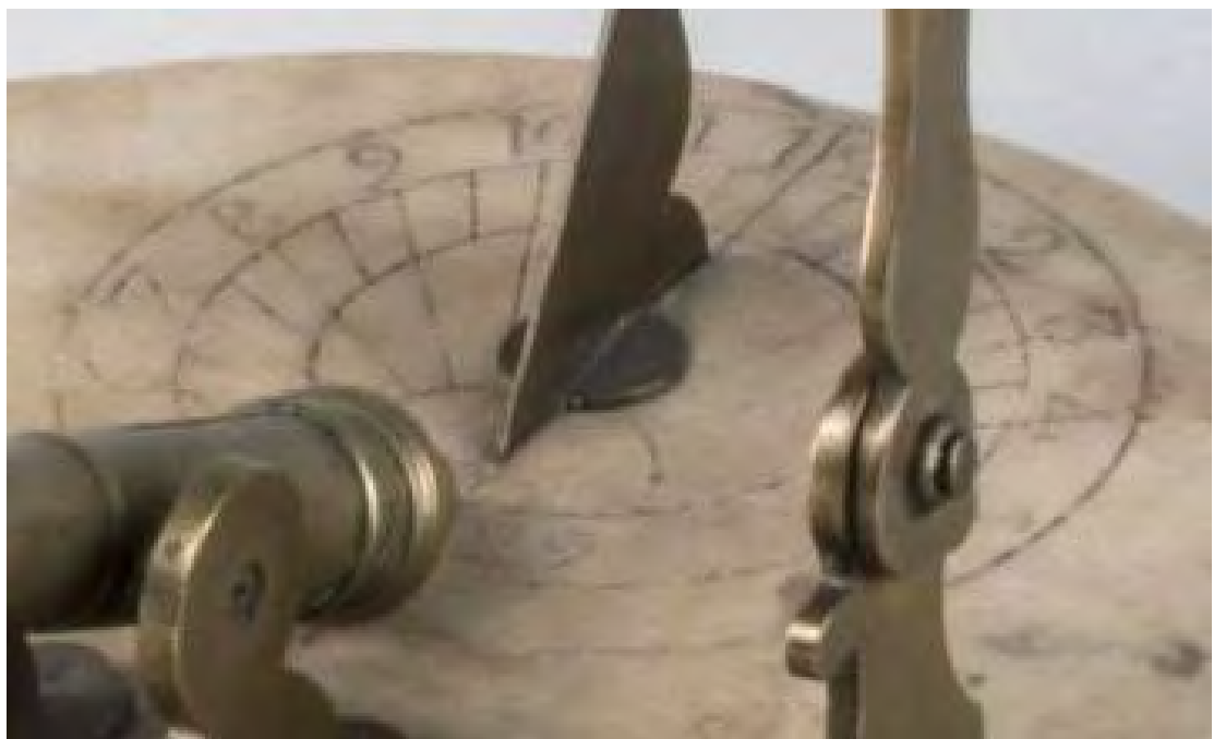
Reloj de sol de forma circular. Cañón y reloj con orientaciones opuestas.
