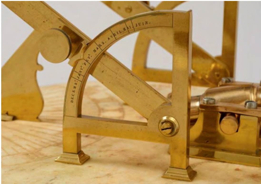
Escala de altura del sol. Abreviaturas de los meses del primer semestre en francés. Mortero desmontable. Gualderas con sobremuñoneras rectas de apertura horizontal.
