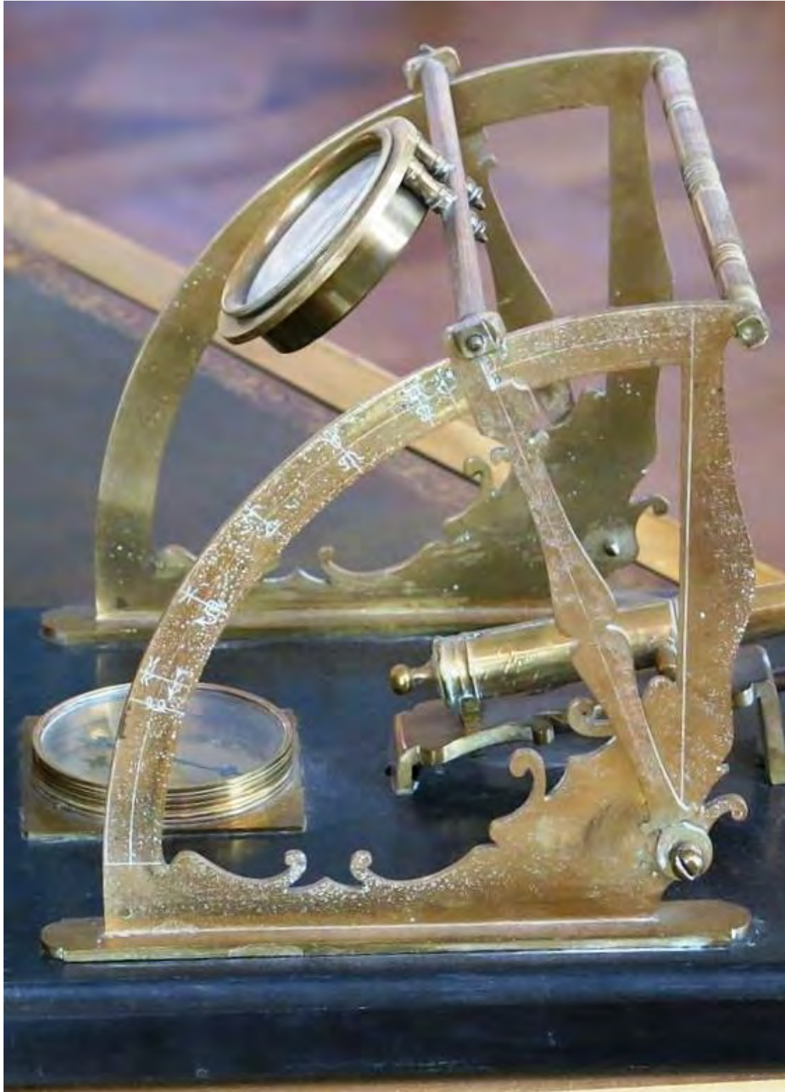
Reloj de sol polar plano universal. Cuadrantes unidos por travesaño sin patas y sin pies. Brújula de doble giro, sobre los brazos y sobre el eje,. Escala de altura del sol. Signos del zodiaco. Muesca rectangular en el brazo derecho para señalar la altura del sol en la escala.
