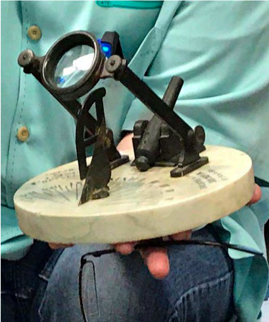
La cureña del cañoncito parece estar colocada al revés.
