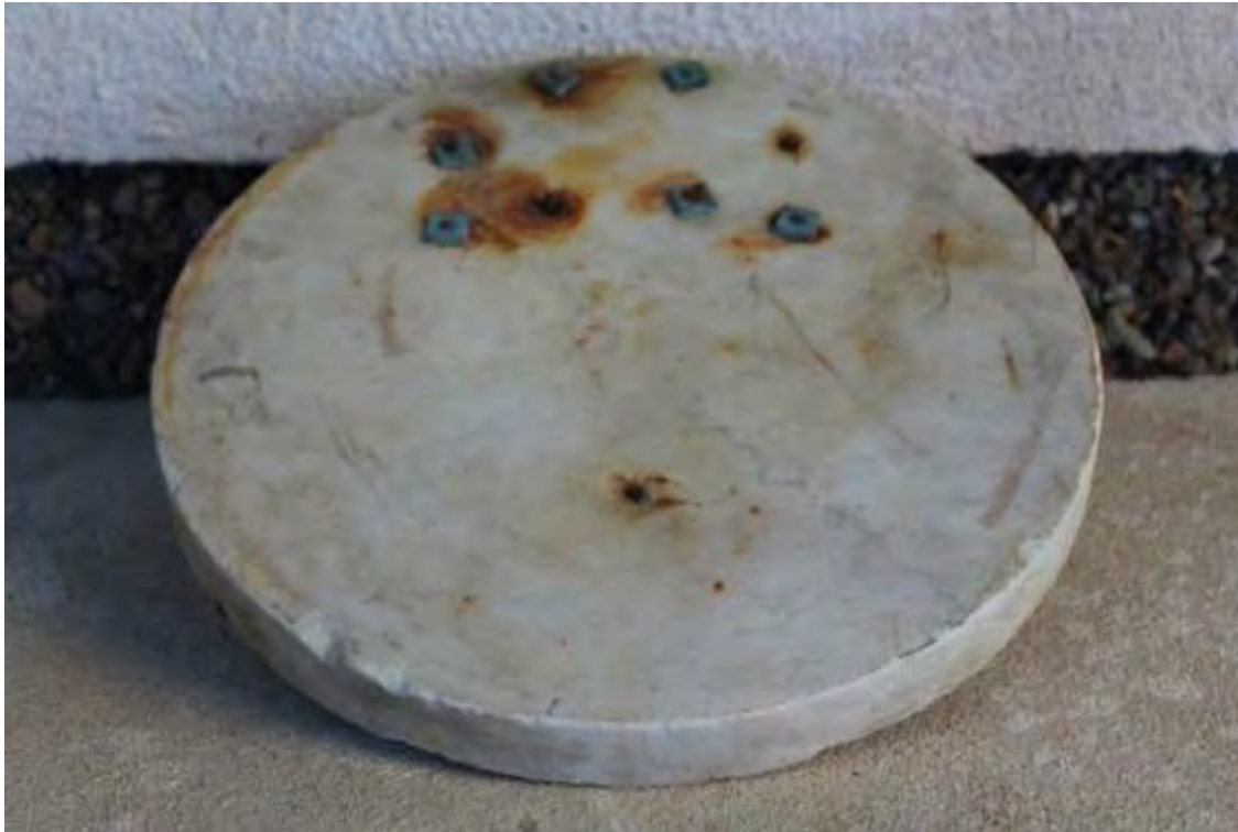
Orificios de sujeción: cañón (4), soportes de la lente (4) y gnomon (1).
