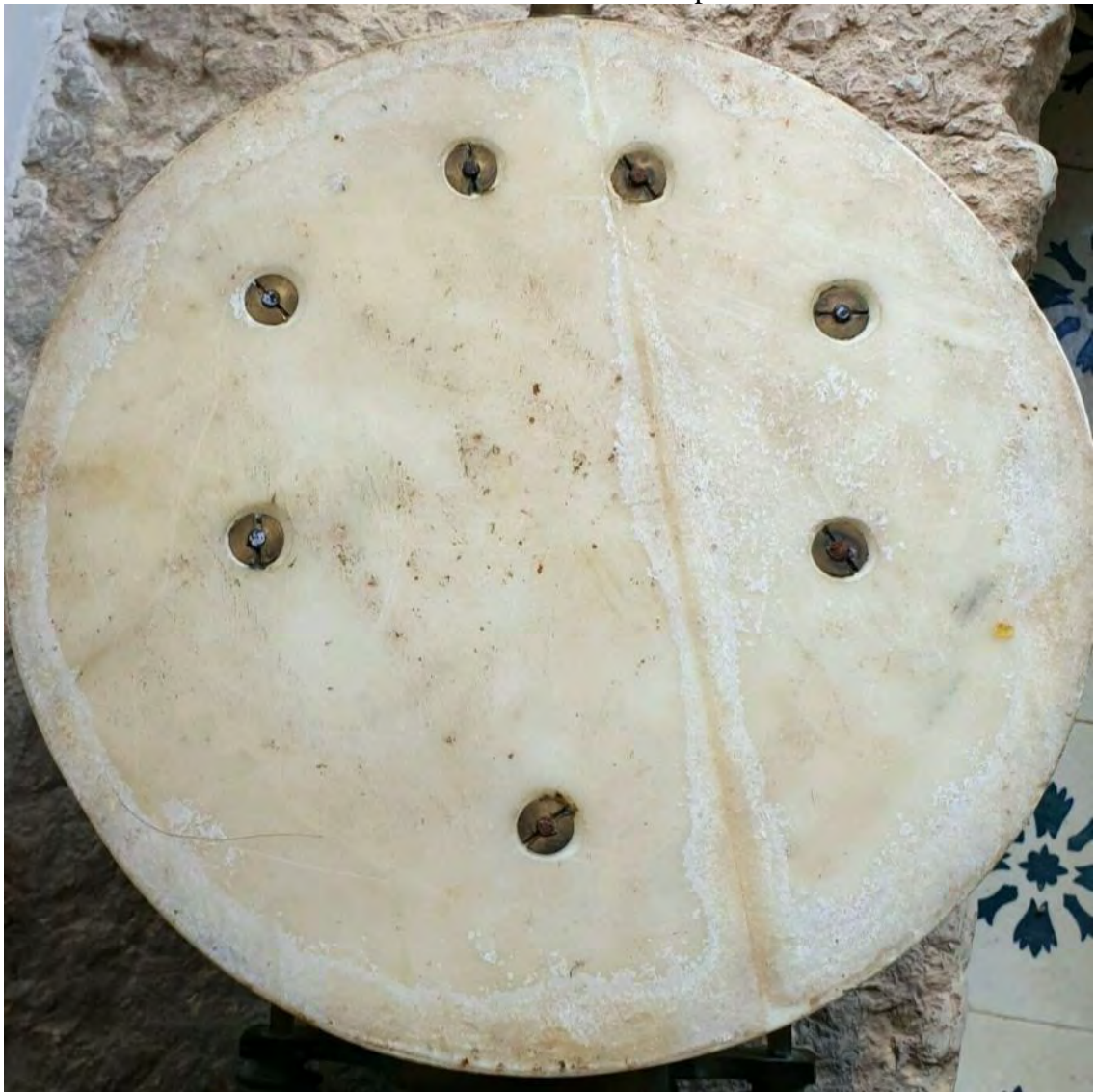
Tornillos de sujeción: gualderas (2), soportes de la lente (2+2), gnomon (1).
