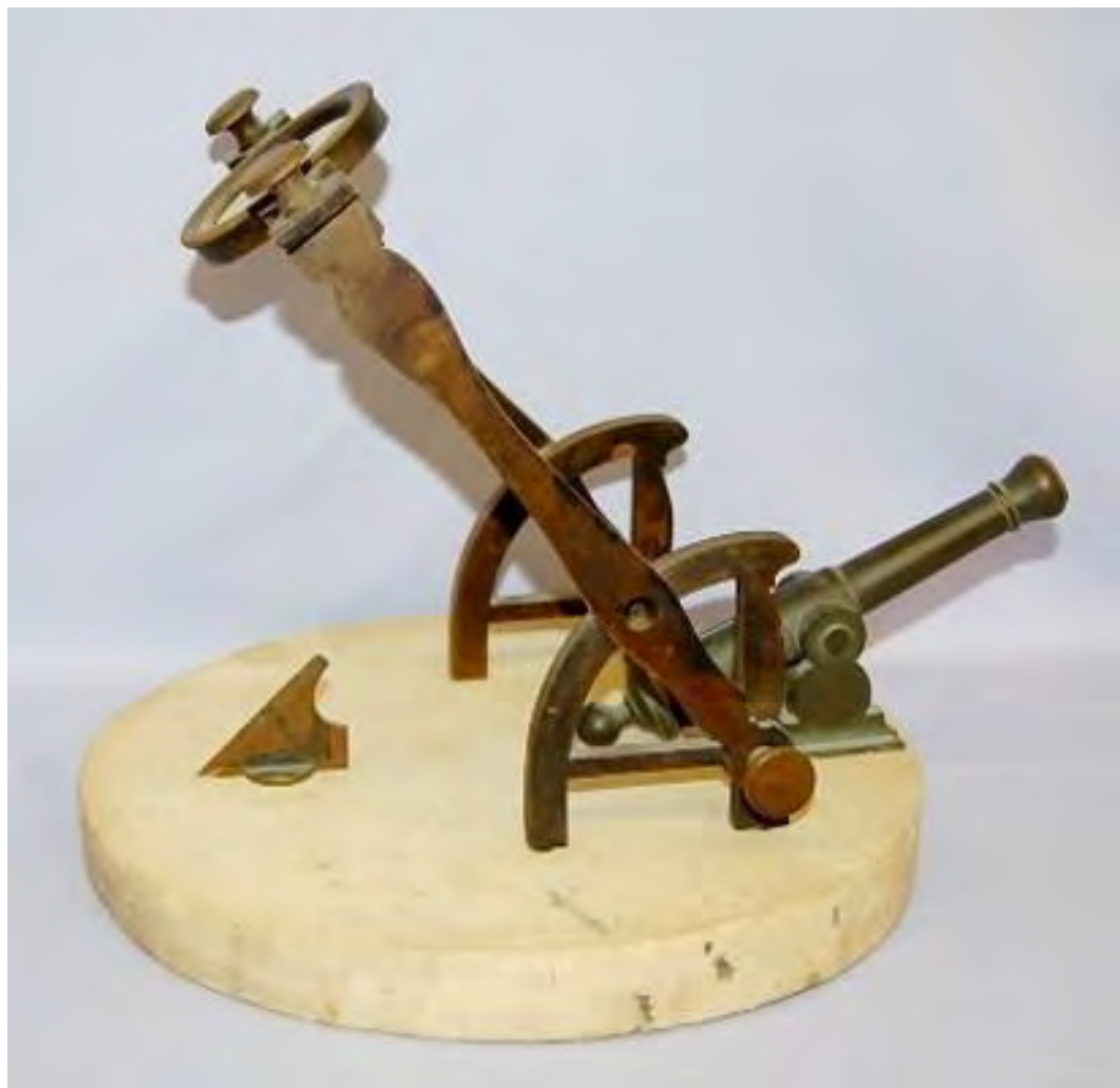
French Noon Time Cannon Sundial Clock: Bronze & Marble; engraved "Par L. Chevalier A Paris Quai de L'Horloge No. 65"; fecha de construcción estimada: 1795-1810.
