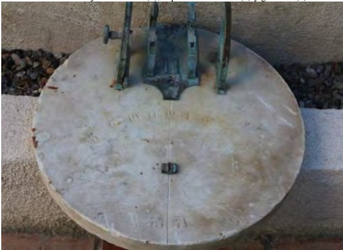
Orificios de sujeción: cañón (4), soportes de la lente (4) y gnomon (1).
