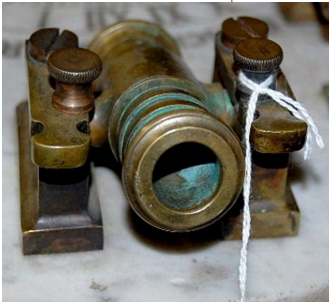
Mortero desmontable. Gualderas con sobremuñoneras rectas de apertura horizontal.
