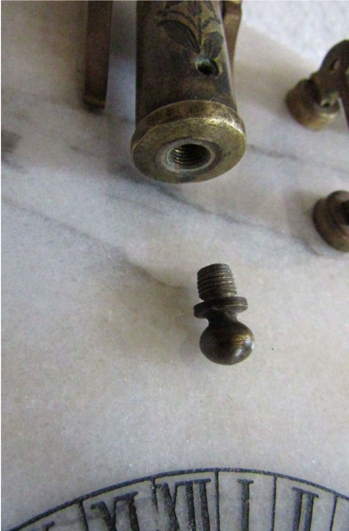
El cascabel de este cañón se puede desenroscar.
