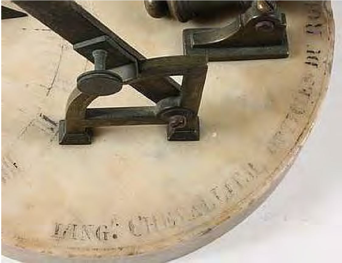
La gualdera derecha lleva un pequeño tornillo que impide el giro del muñón.
