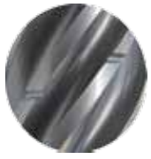
Close-up of chipbreaker grind
