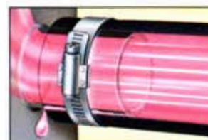
Les colliers réguliers ne s'ajustent pas lors des températures extrêmes de chaleur et cause des fuites. Regular collars do not adjust during extreme heat temperatures and cause leaks.
