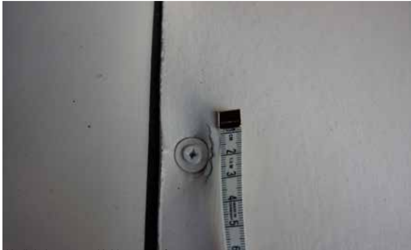
détail de la queue : déchirure et enfoncement.
