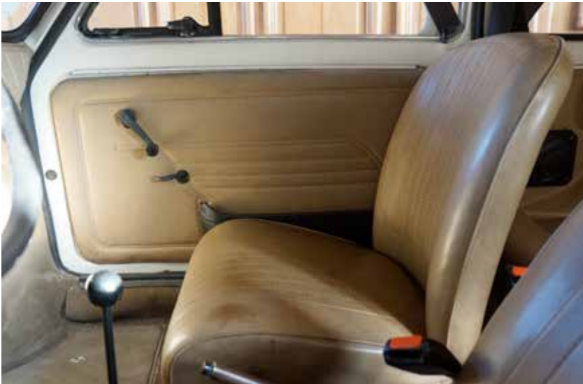
intérieur de la 2.1, au premier plan sur l'assise du siège : frottements
