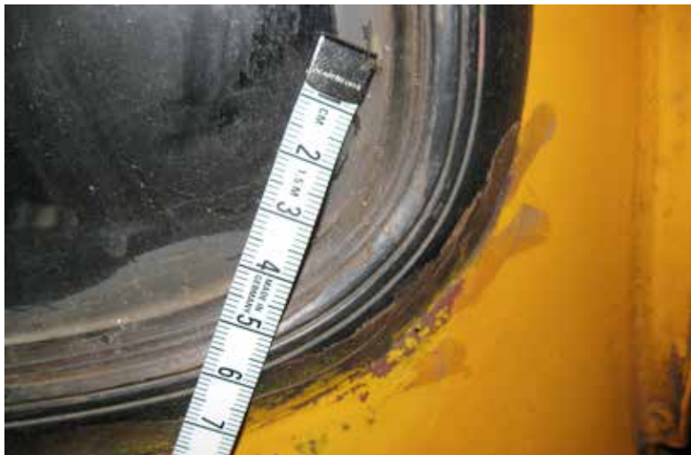
détail du pare brise : coulures, repeints, encrassement des vitres.
