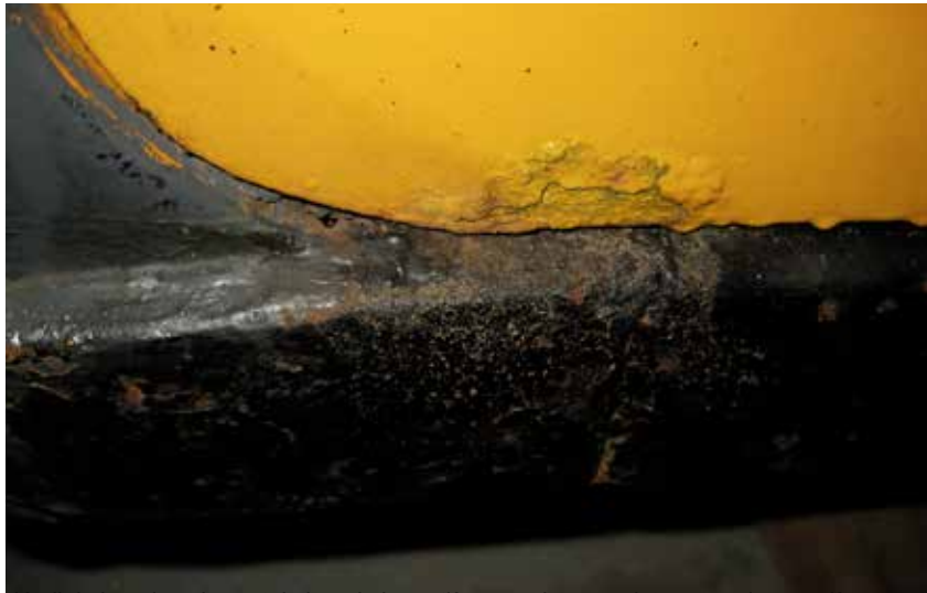
détail du bas de caisse et du bas de la portière gauche : repeints, corrosion, soulèvement, coulures.
