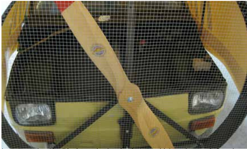
barre en acier décollée à gauche (sur la photographie) au dessus de la pale.
