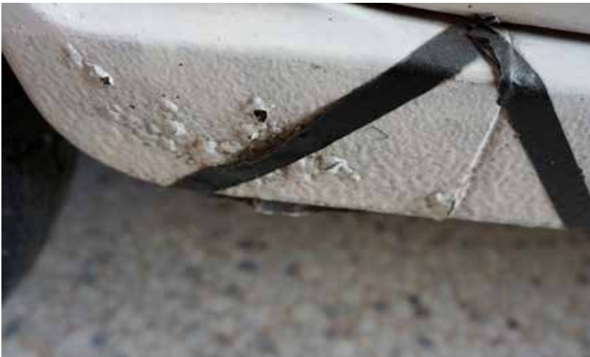
détail du bas de caisse avant gauche : soulèvement de la couche picturale et décollement ruban adhésif.
