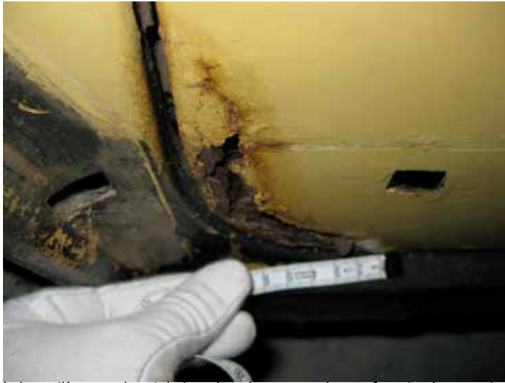
détail de la portière gauche et du bas de caisse, corrosion perforante, lacune et coulures.
