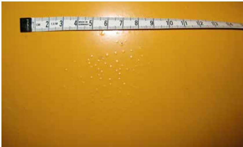
détail du capot : cloques ici et là sur toute la surface : ancienne peinture, puisqu'elles apparaissent également sur les ailes où le repeints de l'artiste est absent.
