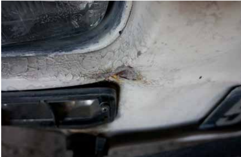
détail du phare droit : frisure et corrosion.
