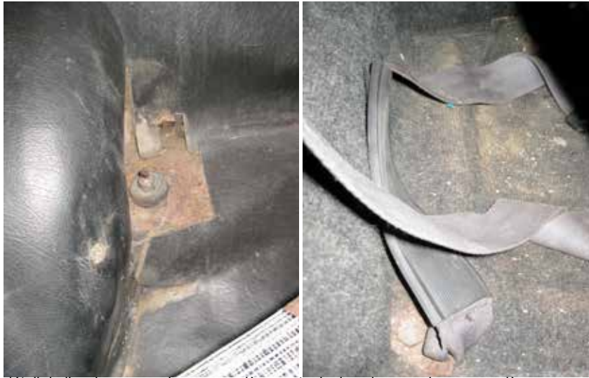
détail de l'assise : corrosion + poussière tapis de sol : corrosion + poussière
