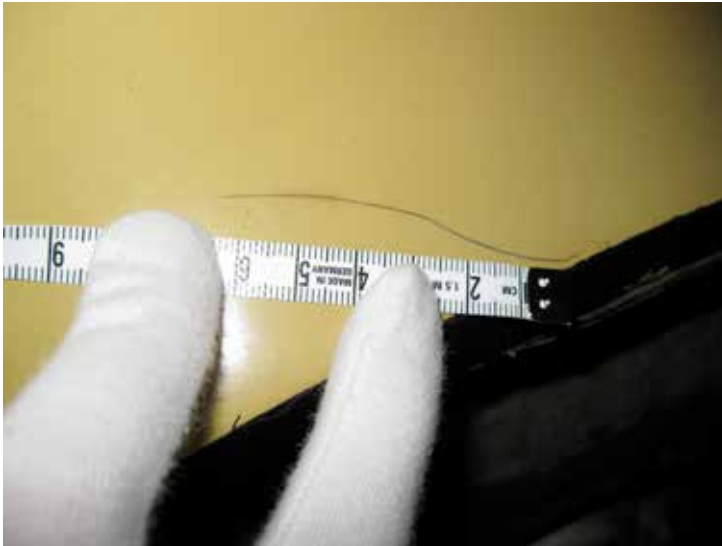
détail du passage de roue arrière gauche : une fissure + corrosion.
