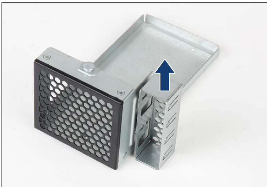
図 304: カバープレートの 2.5 インチダミーケージからの取り外し
