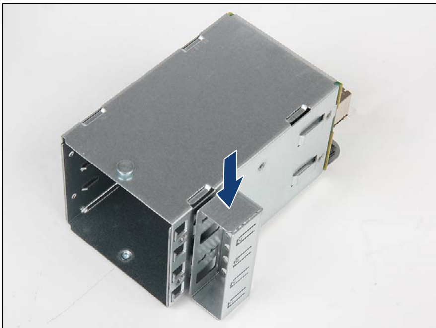
図 300: カバープレートの取り付け
