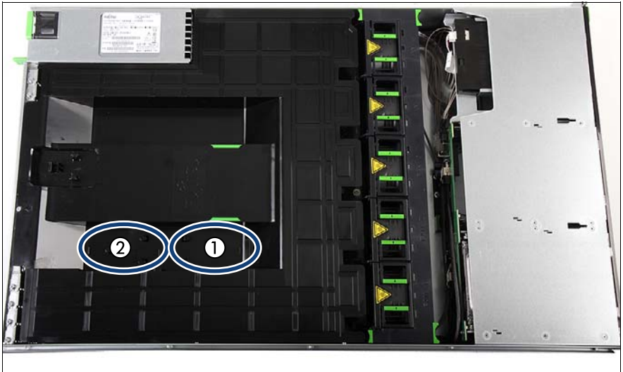
図 100: BBU/FBU の取り付け位置
