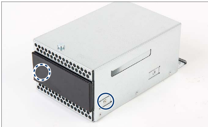
図 209: テープドライブのダミーモジュールの取り付け
