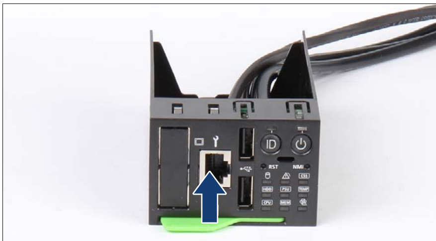
図 255: フロントパネルモジュールからの前面 LAN コネクタの取り外し
