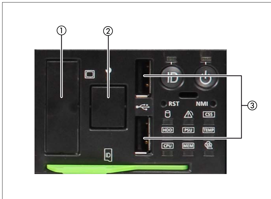
図 344: フロントパネルのコントロールと表示ランプ
