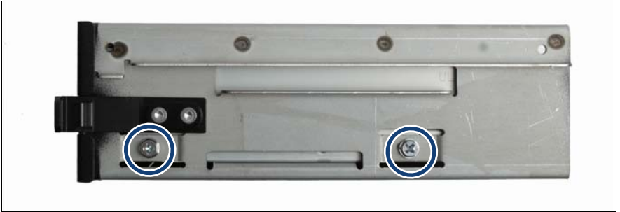
図 188: テープ /RDX ドライブのドライブケースへの固定
