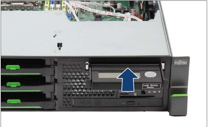
図 171: LSD モジュールの取り付け
