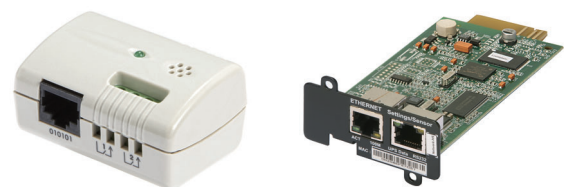
Адаптер Web/SNMP с датчиком параметров окружающей среды.
