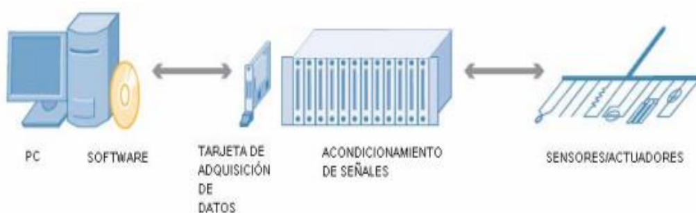
Figura 45. Esquema descriptivo de la adquisición de datos.
