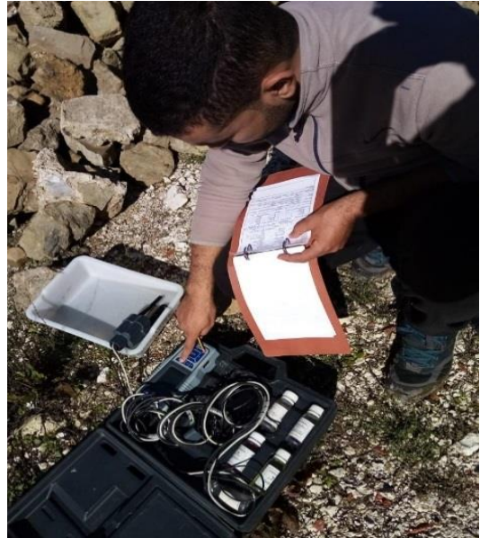
Figure 3.1. Prise de données physico-chimique sur le terrain au moyen d'un appareil multi paramètres portatif
